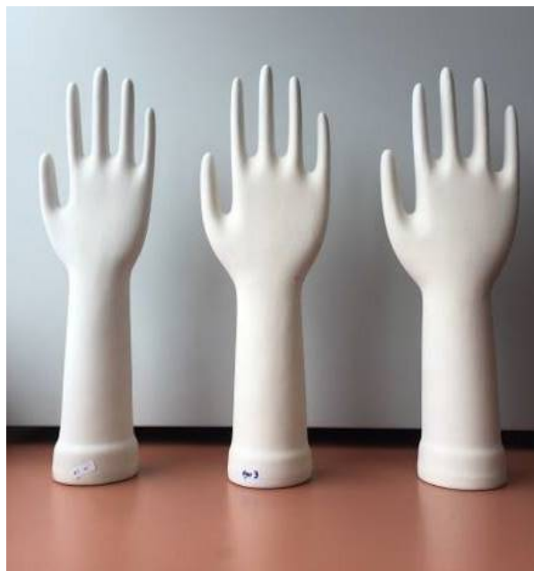
รูปที่ 4.38 ตัวอย่างแบบพิมพ์เซรามิกสูตรดินทดลอง GFB-16 ขนาด M, L และ XL (ตามลำดับซ้ายไปขวา)
