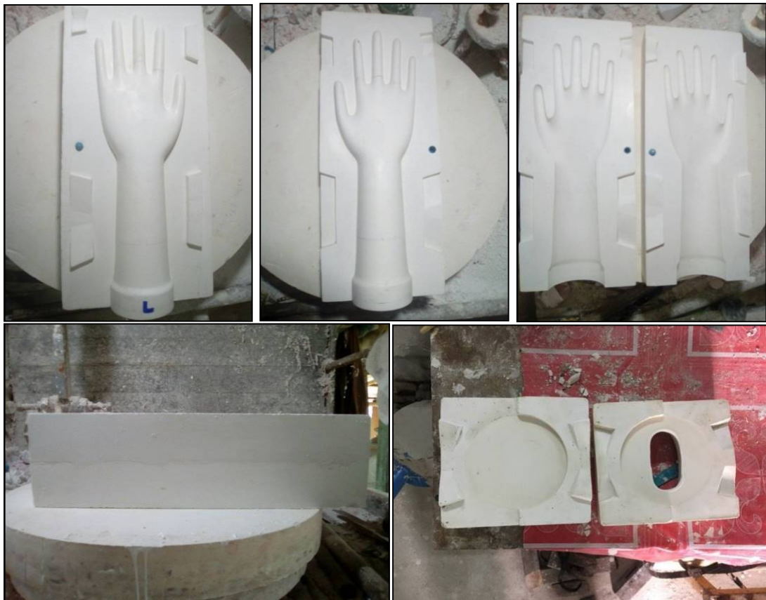
รูปที่ 5 การหล่อแบบพิมพ์ Master mold จากต้นแบบ (Model)
