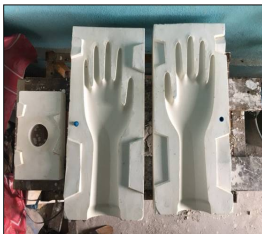
รูปที่ 7 ตัวอย่างแม่พิมพ์สำหรับหล่อน้ำดิน (Working mold)
