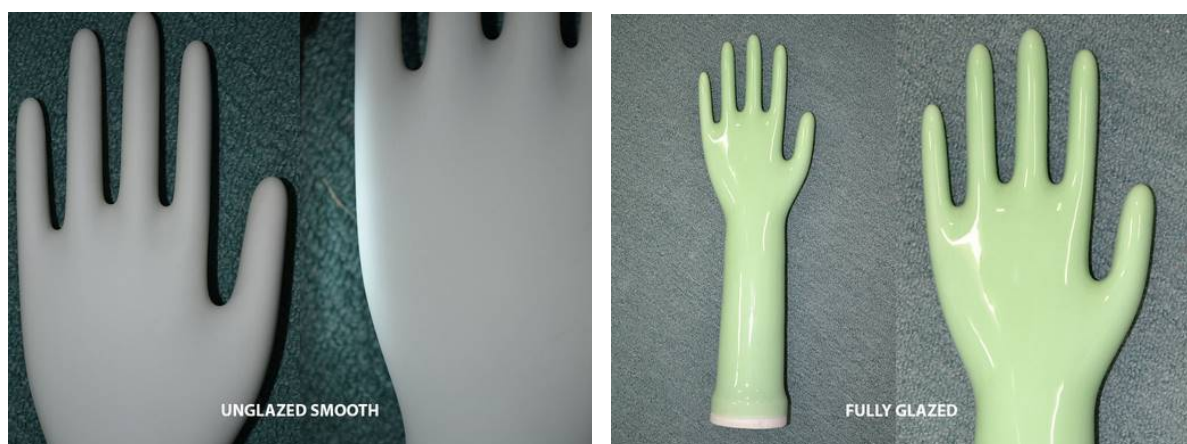
รูปที่ 4.31 ลักษณะแบบพิมพ์เซรามิกชนิดที่ไม่มีเคลือบและมีเคลือบ
