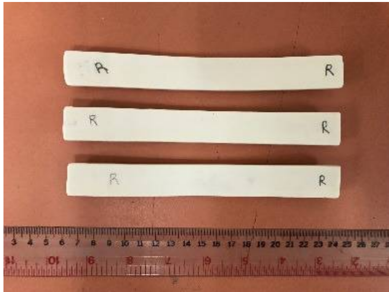
รูปที่ 4.28 ตัวอย่างชิ้นงานทดลองก่อนการทดสอบ Thermal Shock Resistance
