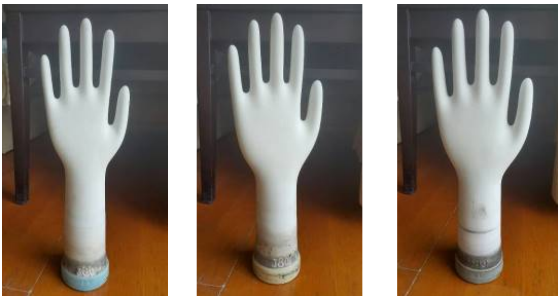
รูปที่ 4.3 แบบพิมพ์เซรามิกขนาด M, L และ XL ที่จะใช้เป็นแม่แบบ
