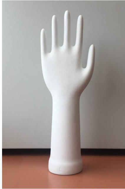
รูปที่ 10 ตัวอย่างต้นแบบภาคนามแบบพิมพ์เซรามิกขนาด L แบบผิวไม่เรียบ (พ่นทราย) ไม่มีเคลือบ
