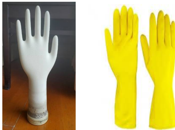
รูปที่ 4.1 ลักษณะแบบพิมพ์ถุงมือยางและถุงมือยางที่ได้จากกระบวนการผลิต
