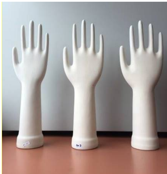
รูปที่ 11 แบบพิมพ์เซรามิกสูตรดินทดลอง GFB-16 ขนาด M, L และ XL (ตามลำดับจากซ้ายไปขวา)
