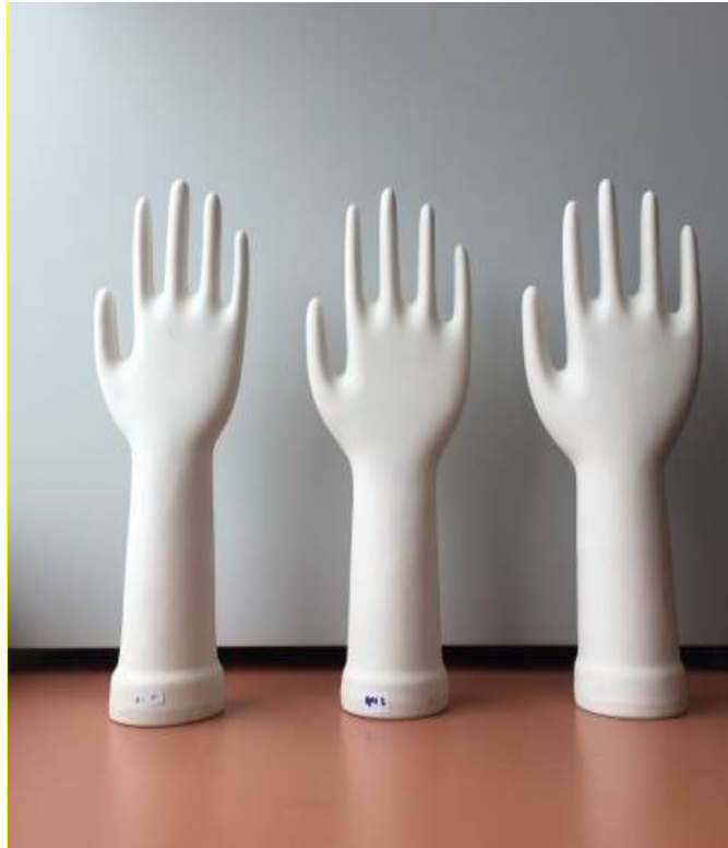
รูปที่ 10 แบบพิมพ์เซรามิกสูตรดินอ้างอิง Body-R ขนาด M, L และ XL (ตามลำดับจากซ้ายไปขวา)
