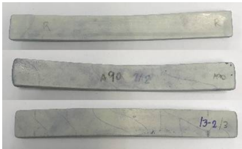
รูปที่ 4.29 ตัวอย่างชิ้นงานทดลองหลังการทดสอบ Thermal Shock Resistance
