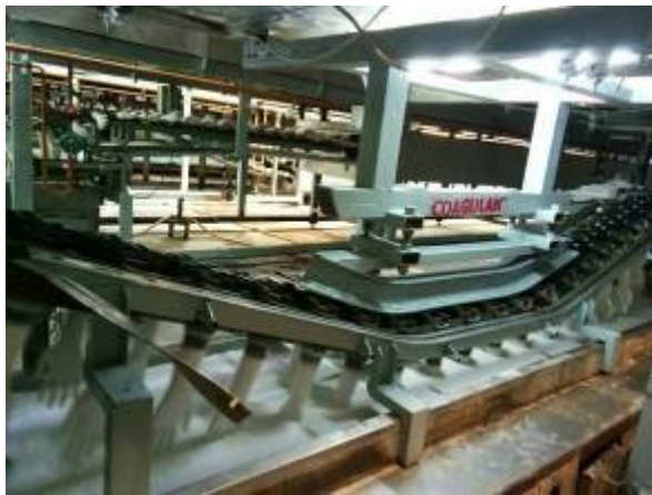
รูปที่ 11 ลักษณะการใช้งานแบบพิมพ์เซรามิกในกระบวนการผลิตถุงมือยาง
