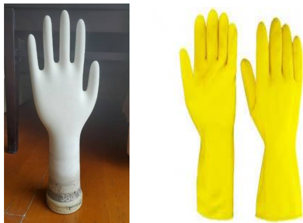
รูปที่ 1 ลักษณะแบบพิมพ์ถุงมือยางและถุงมือยางที่ได้จากกระบวนการผลิต
