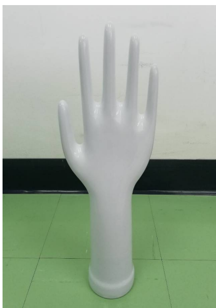
รูปที่ 4.40 ตัวอย่างต้นแบบห้องปฏิบัติการแบบพิมพ์เซรามิกแบบผิวเรียบ เคลือบสูตรอ้างอิง (Glaze-R)
