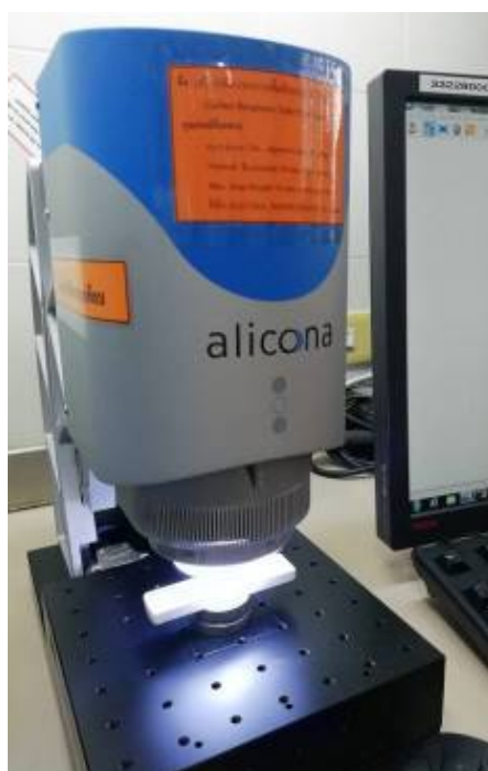
รูปที่ 4.30 เครื่องทดสอบความหยาบพื้นผิวแบบไม่สัมผัส (Surface Roughness Tester – Non Contact)
