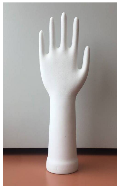
รูปที่ 4.44 ตัวอย่างต้นแบบภาคสนามแบบพิมพ์เซรามิกขนาด L แบบผิวไม่เรียบ (ฟันทราย) ไม่มีเคลือบ
