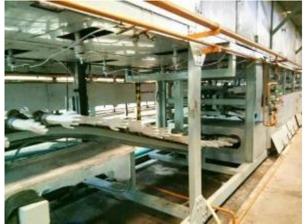
รูปที่ 11 ลักษณะการใช้งานแบบพิมพ์เซรามิกในกระบวนการผลิตถุงมือยาง
