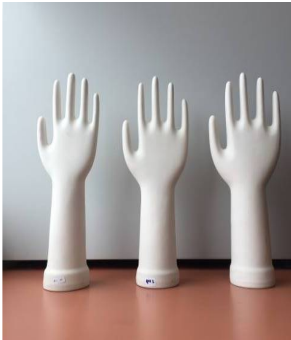
รูปที่ 4.37 ตัวอย่างแบบพิมพ์เซรามิกสูตรดินอ้างอิง Body-R ขนาด M, L และ XL (ตามลำดับซ้ายไปขวา)
