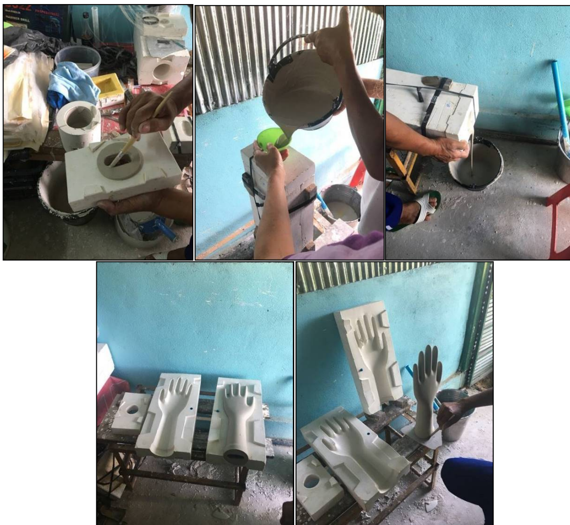
รูปที่ 8 ตัวอย่างการหล่อน้ำดินใน Working mold และการแกะแบบชิ้นงานเป็นต้นแบบ แบบพิมพ์มือตามสูตรเนื้อดินต่างๆ
