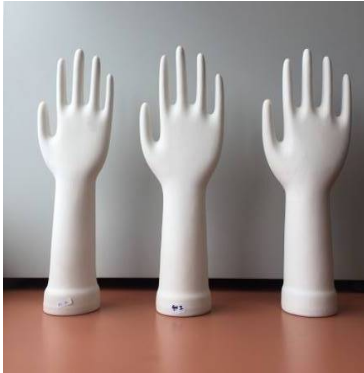
รูปที่ 12 แบบพิมพ์เซรามิกสูตรดินทดลอง A90 ขนาด M, L และ XL (ตามลำดับจากซ้ายไปขวา)
