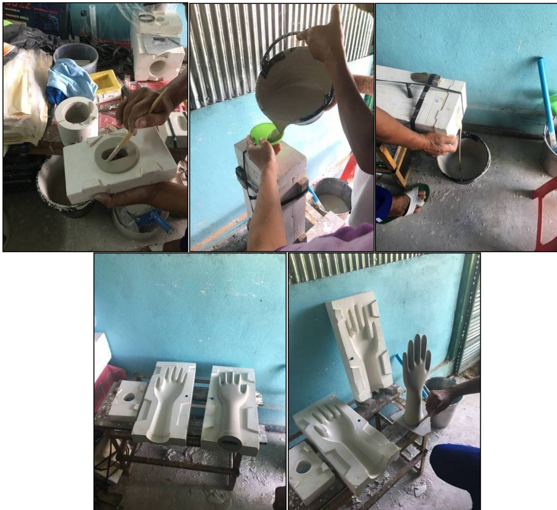
รูปที่ 4.36 ตัวอย่างการหล่อน้ำดินใน Working mold และการแกะแบบขึ้นงานเป็นต้นแบบแบบพิมพ์มือตามสูตรเนื้อดินต่างๆ
