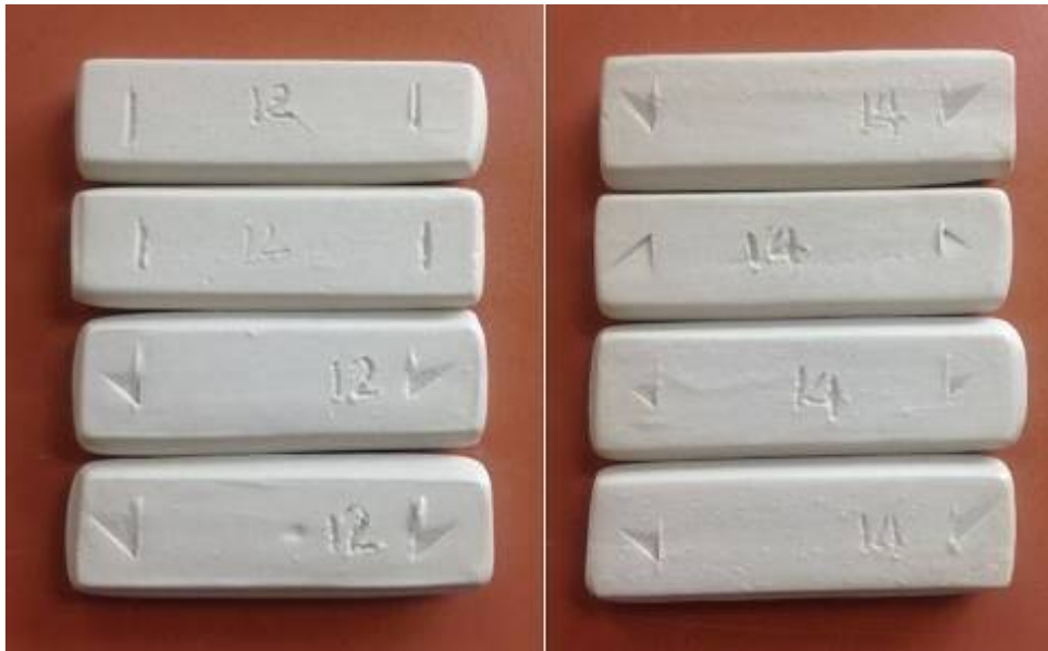
รูปที่ 4.11 ตัวอย่างชิ้นงานทดลองหลังเผาที่อุณหภูมิ 1280°C
