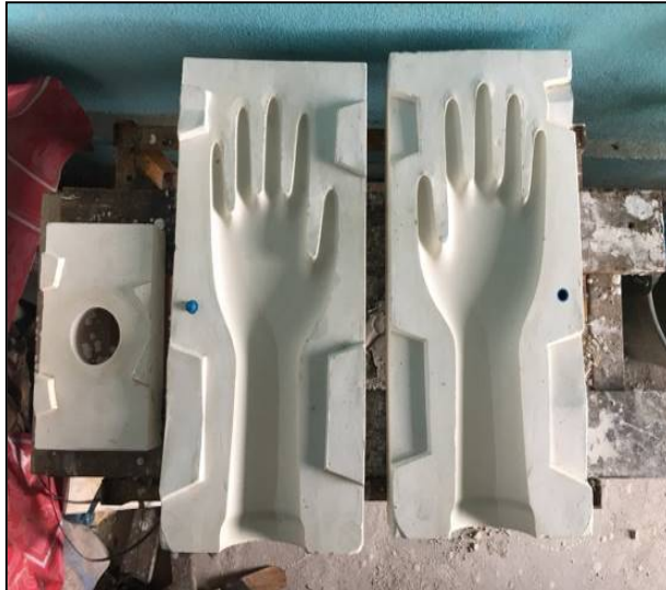
รูปที่ 4.35 ตัวอย่างแม่พิมพ์สำหรับหล่อน้ำดิน (Working mold)
