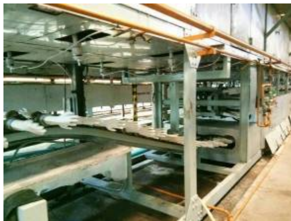
รูปที่ 4.45 ลักษณะการใช้งานแบบพิมพ์เซรามิกในกระบวนการผลิตสูงมียาง
