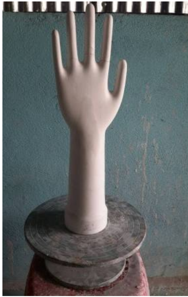
รูปที่ 4 ตัวอย่างแบบพิมพ์มือที่ใช้เป็นต้นแบบ (Model)
