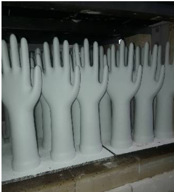
รูปที่ 10 ตัวอย่างต้นแบบภาคนามแบบพิมพ์เซรามิกขนาด L แบบผิวไม่เรียบ (พ่นทราย) ไม่มีเคลือบ
