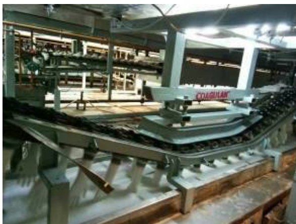
รูปที่ 5 การนำแบบพิมพ์ที่พัฒนาขึ้นไปทดลองใช้จริงในกระบวนการผลิตถุงมือยาง
