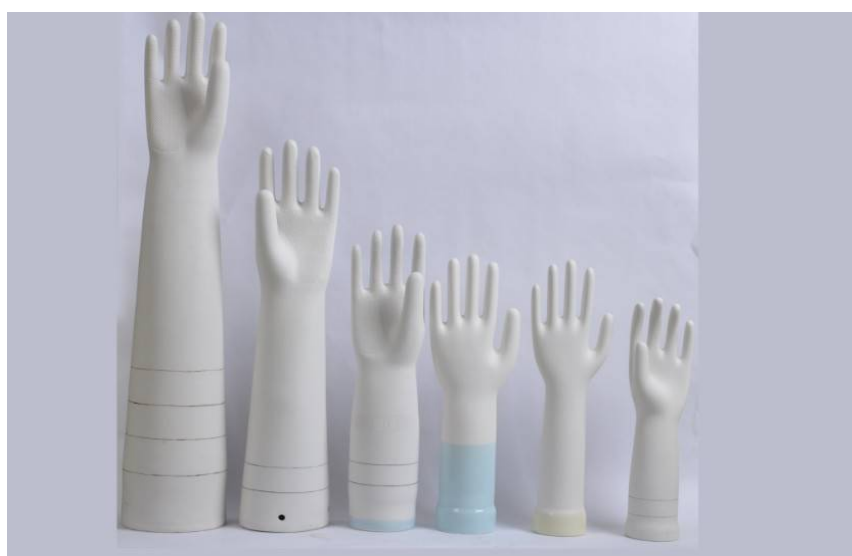
รูปที่ 3 ตัวอย่างแบบพิมพ์ (Formers) สำหรับผลิตถุงมือยาง
