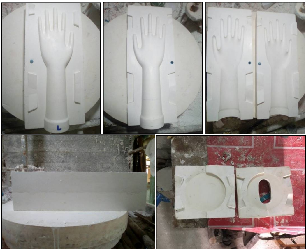
รูปที่ 4.33 การหล่อแบบพิมพ์ Master mold จากต้นแบบ (Model)
