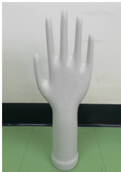
รูปที่ 4.42 ตัวอย่างต้นแบบห้องปฏิบัติการแบบพิมพ์เซรามิกแบบผิวเรียบ เคลือบสูตร GFG-25
