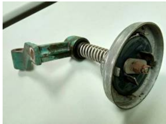
รูปที่ 4.2 ลักษณะฐานของแบบพิมพ์และตัวยึดที่ติดตั้งกับสายการผลิต
