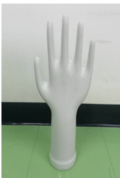
รูปที่ 4.41 ตัวอย่างต้นแบบห้องปฏิบัติการแบบพิมพ์เซรามิกแบบผิวเรียบ เคลือบสูตร GFG-15
