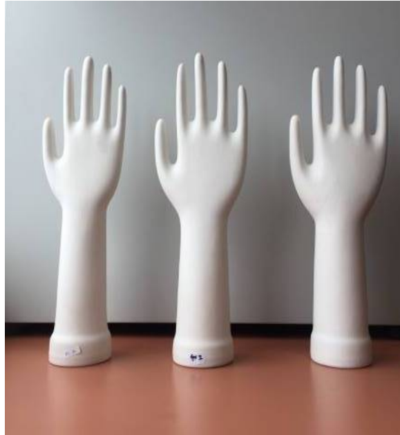
รูปที่ 4.39 ตัวอย่างแบบพิมพ์เซรามิกสูตรดินทดลอง A90 ขนาด M, L และ XL (ตามลำดับซ้ายไปขวา)
