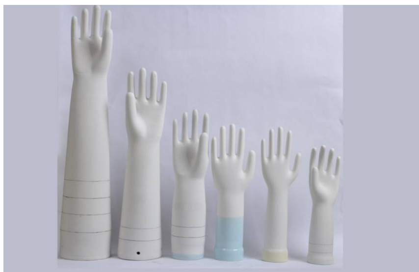
รูปที่ 2.3 ตัวอย่างแบบพิมพ์ (Formers) สำหรับผลิตถุงมือยาง
