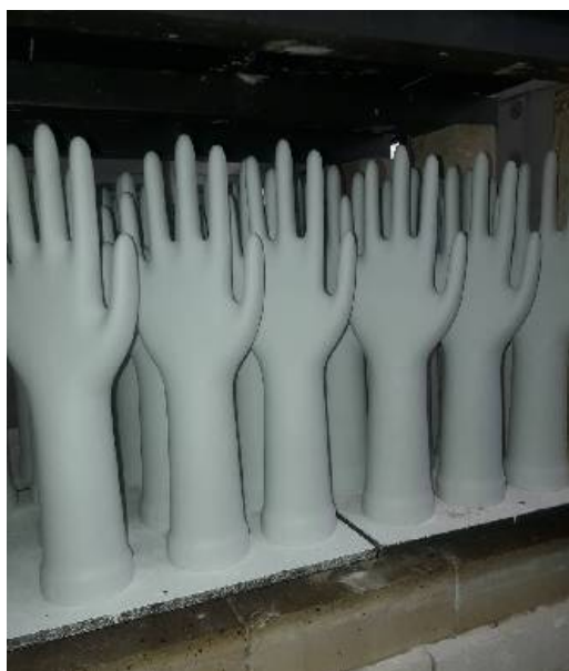
รูปที่ 4.44 ตัวอย่างต้นแบบภาคสนามแบบพิมพ์เซรามิกขนาด L แบบผิวไม่เรียบ (ฟันทราย) ไม่มีเคลือบ
