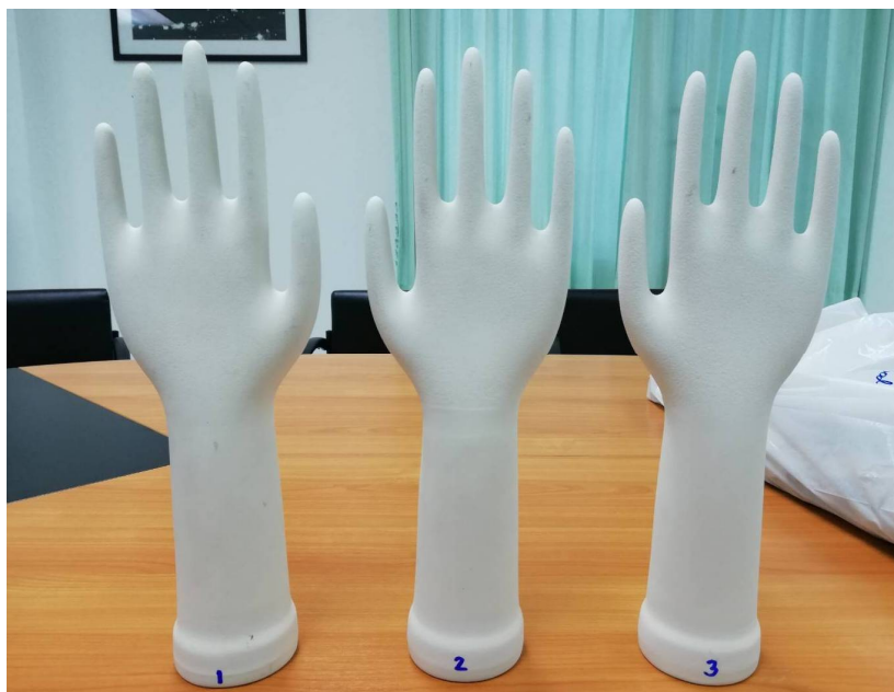
รูปที่ 4.43 ความหยาบของผิวแบบพิมพ์ในระดับ 1-3 จากน้อยไปมาก
