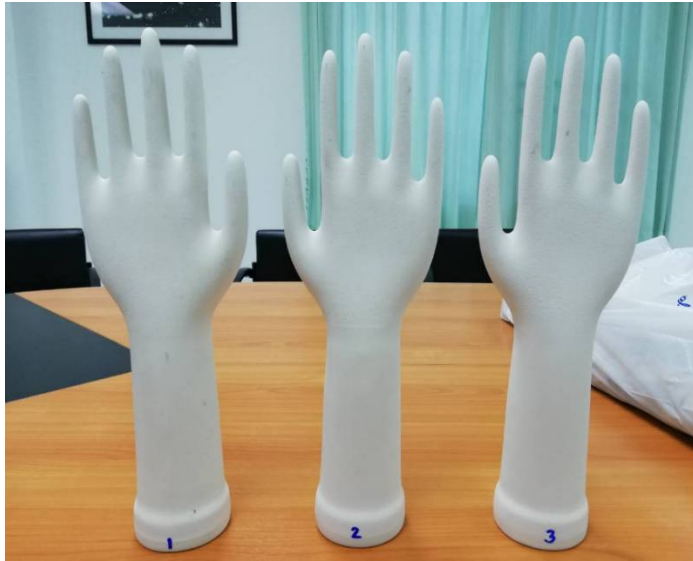
รูปที่ 9 ความหยาบของผิวแบบพิมพ์ในระดับ 1-3 จากน้อยไปมาก
