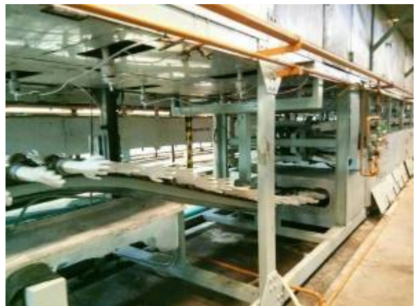
รูปที่ 5 การนำแบบพิมพ์ที่พัฒนาขึ้นไปทดลองใช้จริงในกระบวนการผลิตถุงมือยาง
