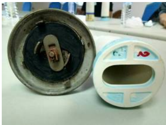
รูปที่ 4.2 ลักษณะฐานของแบบพิมพ์และตัวยึดที่ติดตั้งกับสายการผลิต
