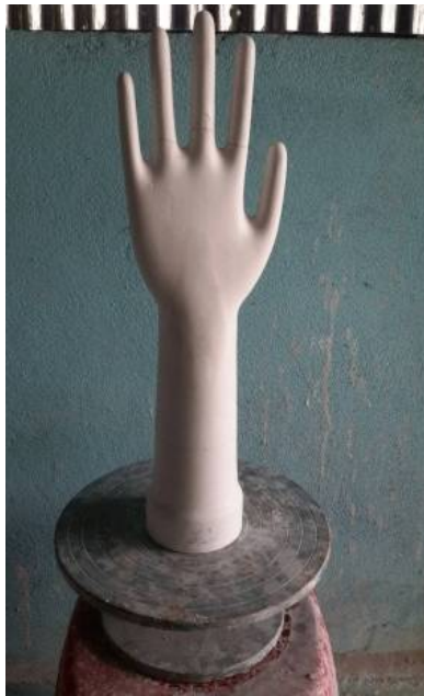
รูปที่ 4.32 ตัวอย่างแบบพิมพ์มือที่ใช้เป็นต้นแบบ (Model)
