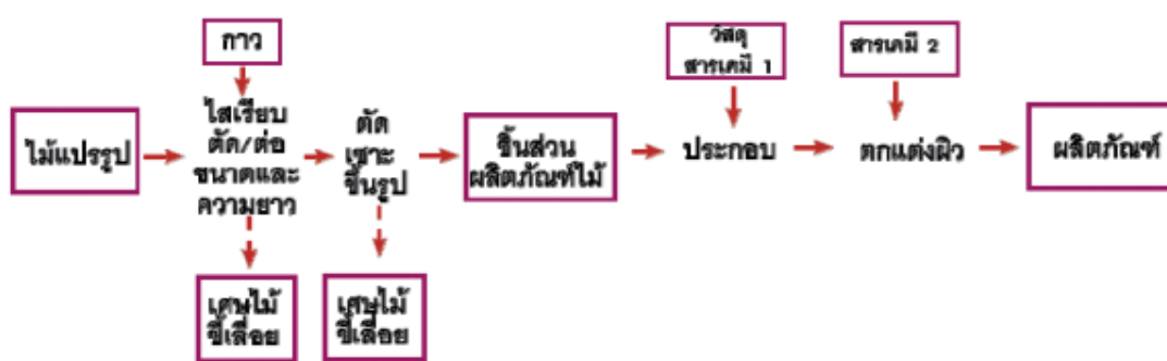
ภาพที่ 5.14 กระบวนการผลิตเฟอร์นิเจอร์
