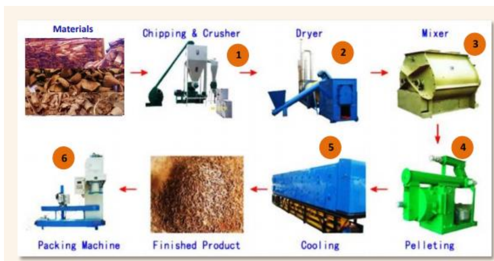
ภาพที่ 5.19 กระบวนการผลิตเชื้อเพลิงชีวมวลอัดเม็ด
