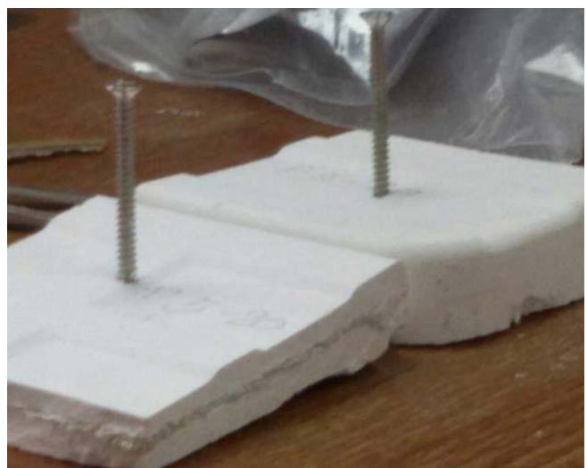
a) รูปแบบการตัดตัวอย่างสำหรับการทดสอบและ b) การยึดติดตะปูของตัวอย่างแผ่นฉาพาดานเพื่อทดสอบแรงยึดติดตะปู
