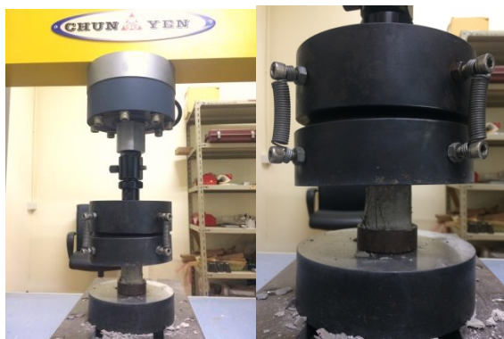
ภาพที่ 16 การทดสอบกำลังอัด
