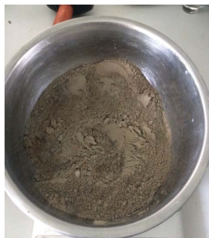
ภาพที่ 9 ปูนซีเมนต์ เถ้าถ่านหินกลวง ไมโครซิลิกา และผสมให้เข้ากัน
