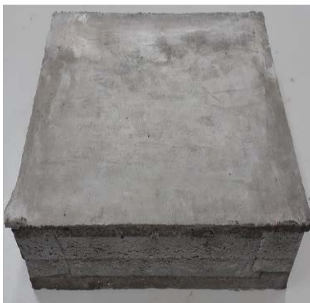
ภาพที่ 27 ตัวอย่างผลิตภัณฑ์อิฐมวลเบาสำหรับผนังอาคาร
