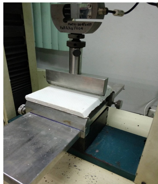
รูปที่ 23 การทดสอบการรับแรงกดอัด แรงดัดโค้งและแรงยึดติดตะปูของตัวอย่างแผ่นฉาพาดาน: a) เครื่องทดสอบการรับแรงทางกล (UTM), b) การทดสอบแรงยึดติดตะปู, c) และ d) การทดสอบการรับแรงกดอัด (Compressive strength)
