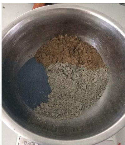
ภาพที่ 9 ปูนซีเมนต์ เถ้าถ่านหินกลวง ไมโครซิลิกา และผสมให้เข้ากัน
