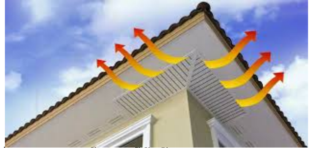
รูปที่ 2 การติดตั้งฝ้าเพดานเพื่อช่วยระบายความร้อนภายใต้หลังคา
