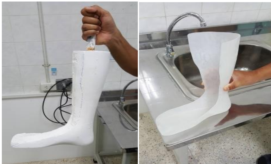
แผนภาพที่ 4.3 แสดงการทำแบบประกอบด้านนอกด้วยวัสดุชนิดพลาสติก Medical grade
