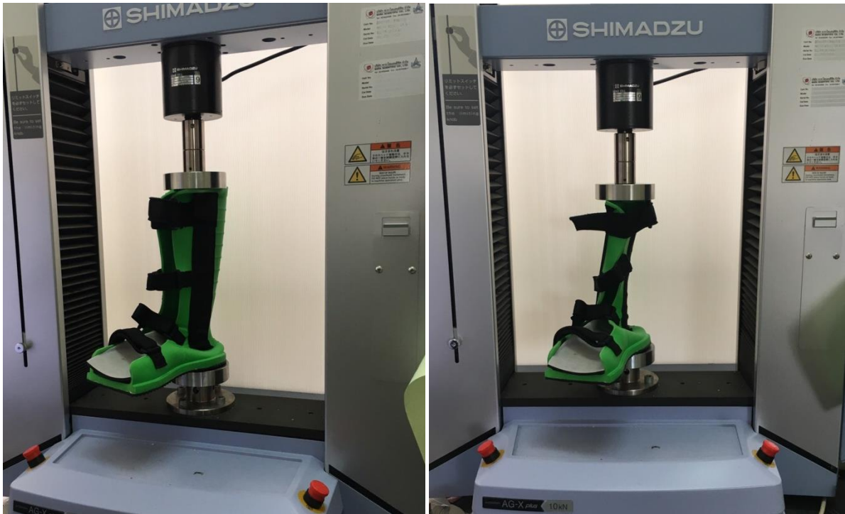
แผนภาพที่ 4.16 แสดงการกดเฟือกยางพารา ด้วยเครื่อง Shimadzu แบบ compression
