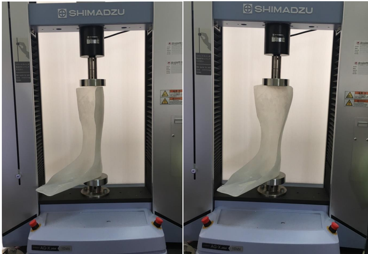
แผนภาพที่ 4.18 แสดงการกดเฟือกที่ทำจากแผ่นยางพาราแข็งด้วยเครื่อง Shimadzu แบบ compression
