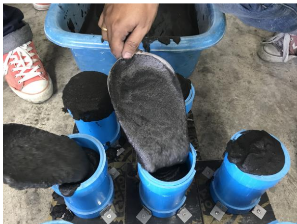
รูปที่ 3.17 การเทมวลเบาแบบเซลลูโลสจากเก้าชานอ้อยจีโอโพลิเมอร์ผสมเถ้าลอยหรือปูนซีเมนต์ปอร์ตแลนด์ลงในแบบหล่อ
