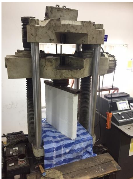
รูปที่ 3.25 ลักษณะการทดสอบกำลังอัดของบล็อกเชียวมวลเบาแบบเซลลูล่าจากเถ้าขานอ้อยจีโอโพลิเมอร์ผสมเถ้าลอยหรือปูนซีเมนต์ปอร์ตแลนด์เมื่อหล่อเป็นผนัง
