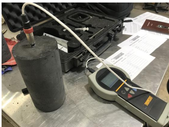
รูปที่ 3.21 ลักษณะการทดสอบค่าสัมประสิทธิ์การนำความร้อนของบล็อกเชียวมวลเบาแบบเซลลูโลสจากเถาขานอ้อยจีโอโพลิเมอร์ผสมเถ้าลอยหรือปูนซีเมนต์ปอร์ตแลนด์
