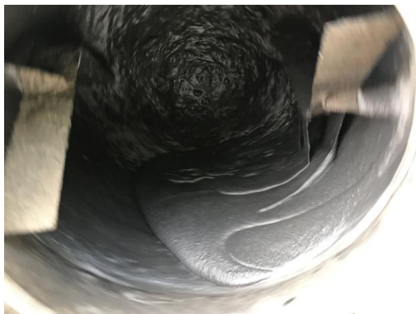
รูปที่ 3.12 ลักษณะการผสมมวลเบาแบบเซลลูล่าจากเถ้าขานอ้อยจีโอโพลิเมอร์ผสมเถ้าลอยหรือปูนซีเมนต์ปอร์ตแลนด์
