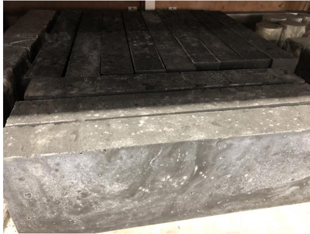
รูปที่ 3.22 ลักษณะตัวอย่างบล็อกเชิยมวลเบาแบบเซลลูล่าจากเถ้าขานอ้อยจีโอโพลิเมอร์ผสมเถ้าลอยหรือปูนซีเมนต์ปอร์ตแลนด์เมื่อหล่อเป็นผนัง
