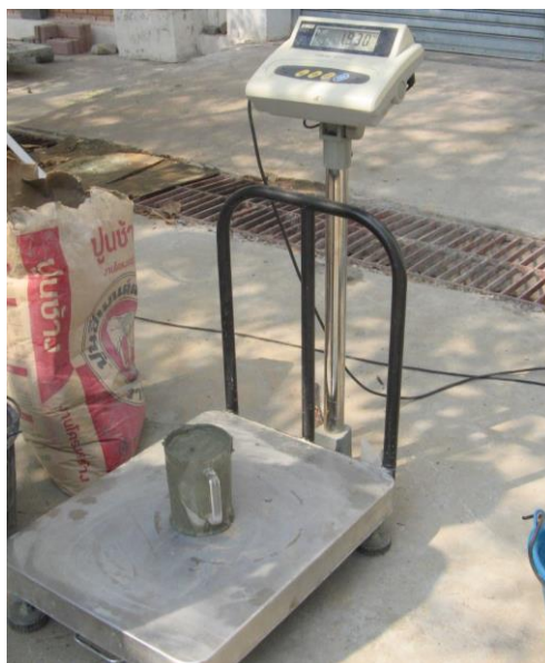
รูปที่ 3.16 การตรวจสอบความหนาแน่นเปียกของมวลเบาแบบเซลลูล่าจากเถาขานอ้อยจีโอโพลิเมอร์ผสมเถ้าลอยหรือปูนซีเมนต์ปอร์ตแลนด์
