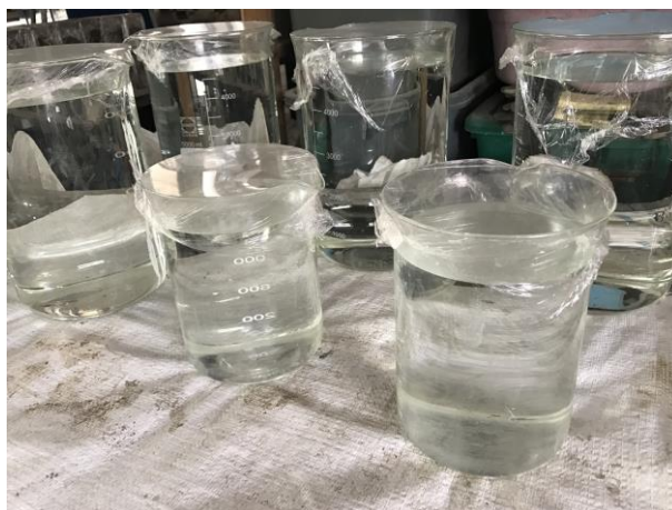
รูปที่ 3.10 การเตรียมสารละลายโซเดียมไฮดรอกไซด์
