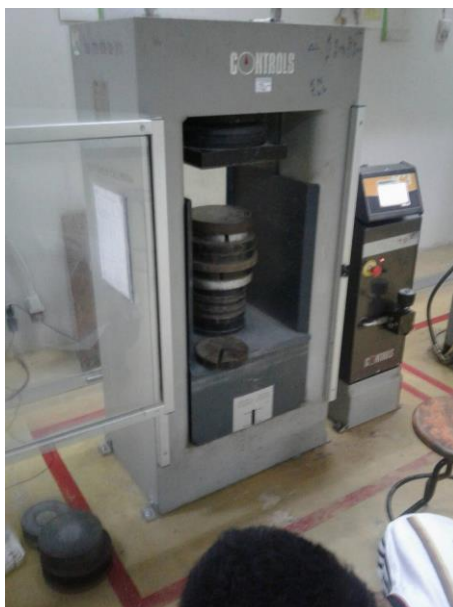
รูปที่ 3.19 การทดสอบของมวลเบาแบบเซลลูโลสจากเถาขานอ้อยจีโอโพลิเมอร์ผสมเถ้าลอยหรือปูนซีเมนต์ปอร์ตแลนด์
