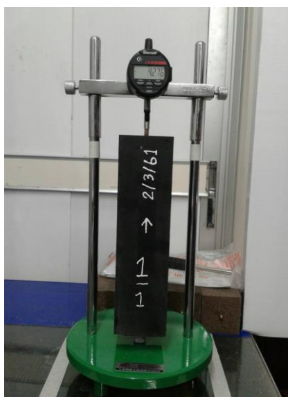
รูปที่ 3.20 ลักษณะการทดสอบค่าการหดตัวแห้งของบล็อกเชียวมวลเบาแบบเซลลูโลสจากเถาขานอ้อยจีโอโพลิเมอร์ผสมเถ้าลอยหรือปูนซีเมนต์ปอร์ตแลนด์
