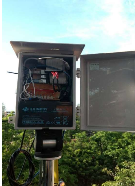
รูปที่ 3-18 นำแบตเตอรี่ขนาด 12 โวลต์ ใส่เข้าไปในบรรจุภัณฑ์พร้อมกับสายแบตเตอรี่ให้ถูกต้อง
