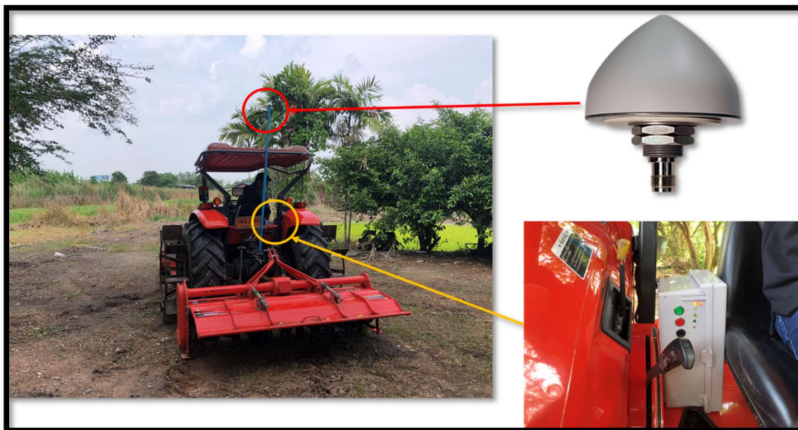
รูปที่ 3-20 ภาพการติดตั้งอุปกรณ์สถานีจลน์บนรถทางเกษตรกรรม
