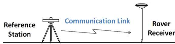
รูปที่ 2-4 การใช้งานระบบ RTK ในทางปฏิบัติ
