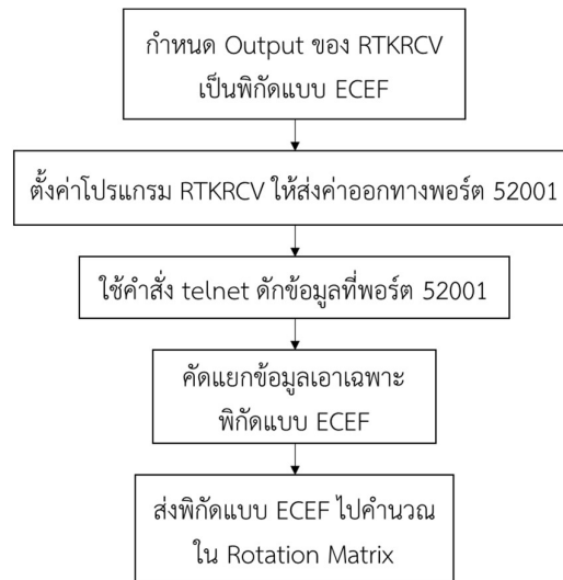
รูปที่ 3-14 การนำพิกัดจากโปรแกรม RTKRCV ไปคำนวณใน Rotation Matrix
