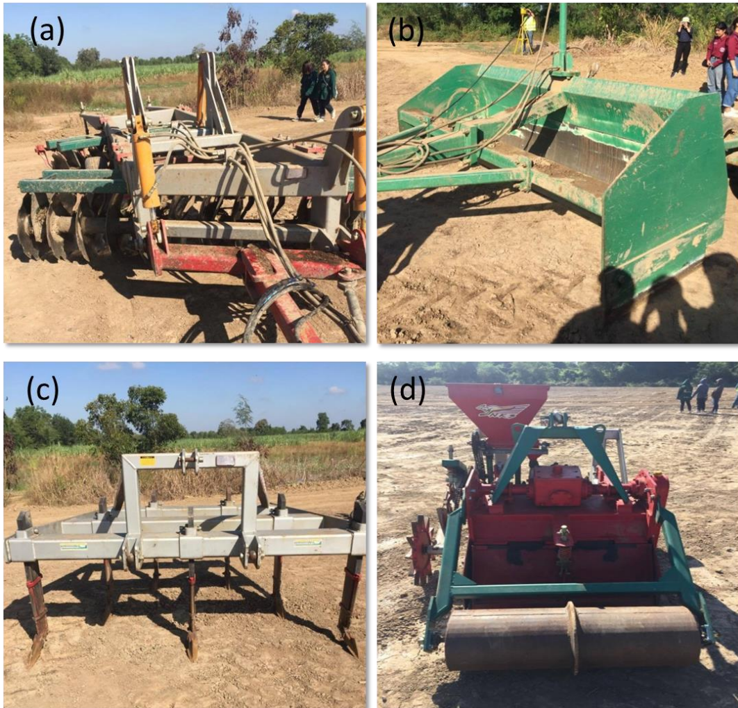
ภาพผนวกที่ 1 ตัวอย่างเครื่องมือที่ใช้ดำเนินงานวิจัย (a) ฝาลพรวน 24 จาน (b) เกรดเดอร์ (grader) ที่ปรับระดับดิน (c) ริปเปอร์ (ripper) และ (d) มินิคอมบาย (mini combine)
