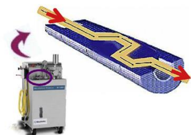
ภาพที่ 12 เครื่องไมโครฟลูอิดเซอร์ microfluidizer (M-110EH 30) และ Z-chamber
