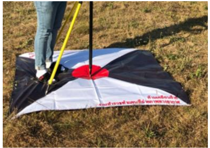
รูปที่ 4.4 การกำหนดตำแหน่งหมุดควบคุมภาคพื้นดิน (GCP) และหมุดตรวจสอบ (CP) โดยการปูผ้าสัญลักษณ์ ขนาด 1.50 x 1.50 เมตร
