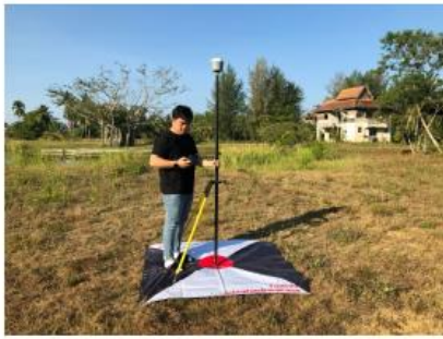
รูปที่ 4.6 แสดงการหาค่าพิกัดหมุดควบคุมภาคพื้นดิน (GCP) และหมุดตรวจสอบ (CP) โดยใช้เครื่องรับสัญญาณดาวเทียม GNSS
