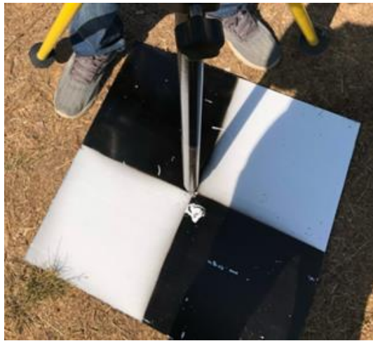
รูปที่ 4.4 การกำหนดตำแหน่งหมุดควบคุมภาคพื้นดิน (GCP) และหมุดตรวจสอบ (CP) โดยการปูผ้าสัญลักษณ์ ขนาด 1.50 x 1.50 เมตร
