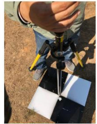
รูปที่ 4.6 แสดงการหาค่าพิกัดหมุดควบคุมภาคพื้นดิน (GCP) และหมุดตรวจสอบ (CP) โดยใช้เครื่องรับสัญญาณดาวเทียม GNSS
