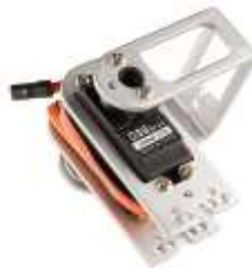
ภาพที่ 2.3 มอเตอร์เซอร์โวที่ควบคุมโดยใช้สัญญาณ PWM
