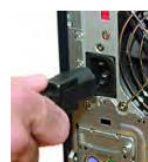
ภาพที่ 4-26 สายไฟด้านหลังเครื่อง
