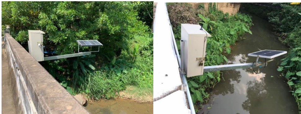
ภาพที่ 4.44 ตู้ส่งข้อมูลระดับน้ำและอัตราการไหล
