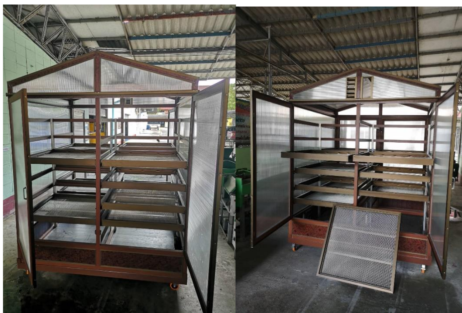
ภาพที่ 4.13 โรงอบแห้งพลังงานแสงอาทิตย์
