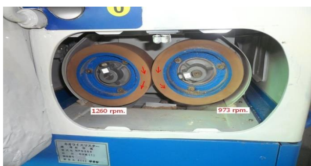
ภาพที่ 2.19 ส่วนประกอบของเครื่องกะเทาะแบบโม้หินแนวนอน ที่มา : เกษตรพอเพียง.คอม : ออนไลน์
