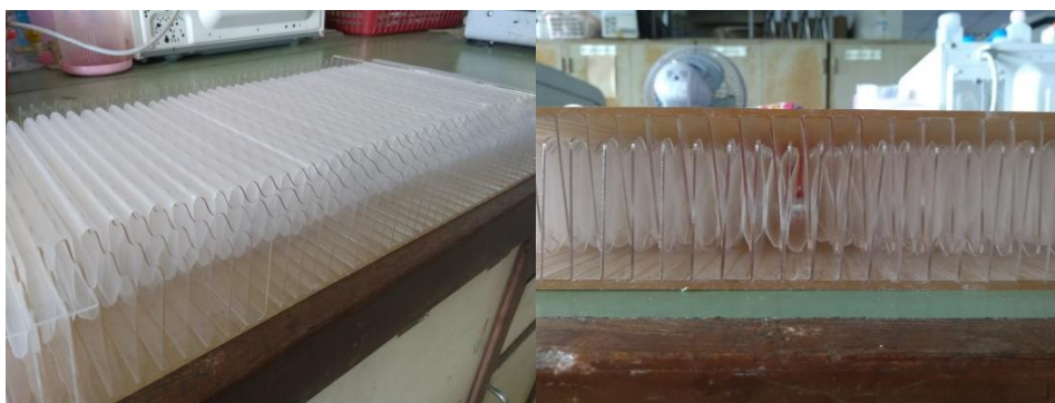
รูปที่ 7 การประกอบท่อเมมเบรนพอลิเมอร์ในโมดูล
