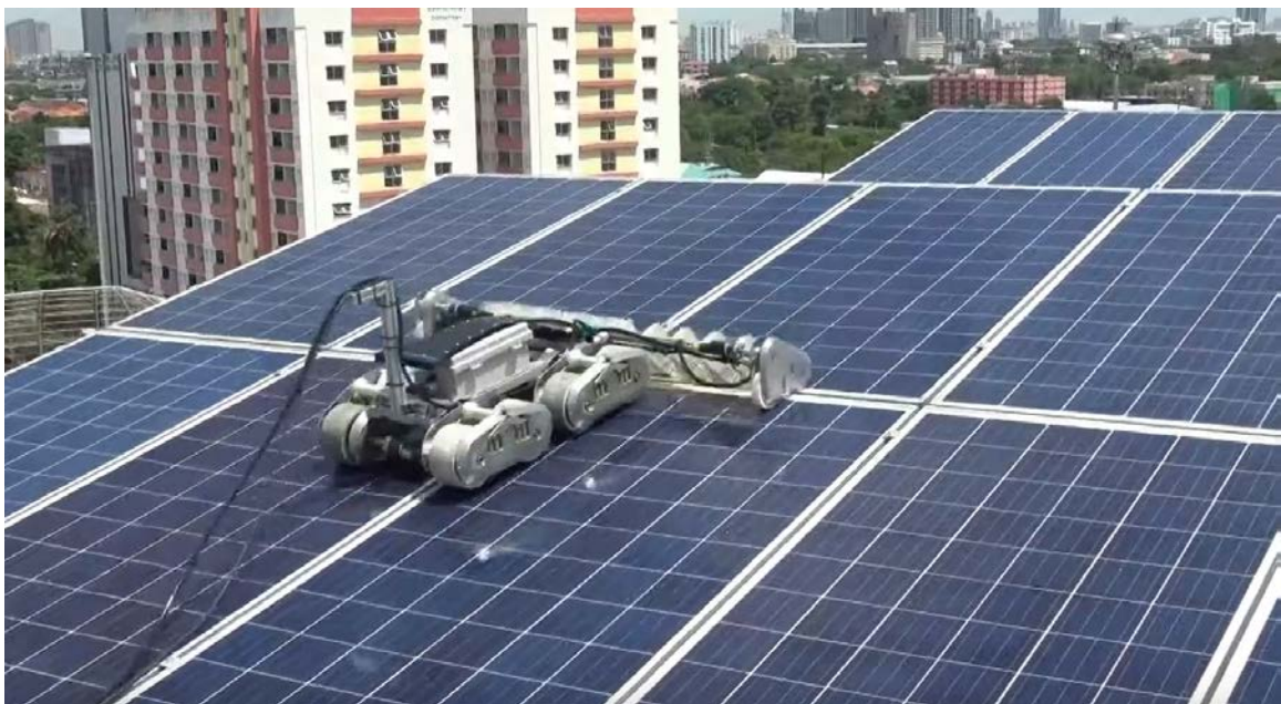
รูปที่ 4.53 การทดสอบการทำงานของหุ่นยนต์แบบ rooftop ความเร็วในการเคลื่อนที่ขึ้นลง และด้านข้าง
