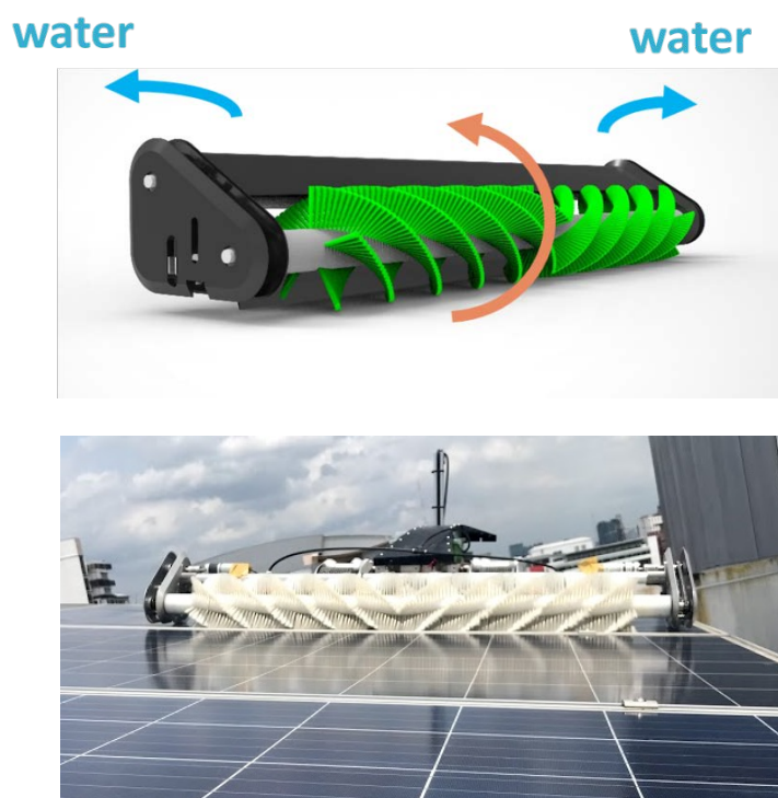
รูปที่ 4.27 การทดสอบการทำงานของแปรงในการรีดน้ำออกด้านข้าง
