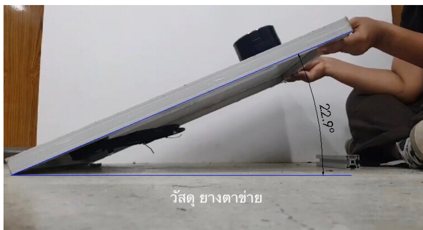
รูปที่ 4.32 ตัวอย่างการทดสอบแผ่นยางกันลื่นกับแผงเซลล์แสงอาทิตย์ที่แห้งทำมุมได้ 22.9 องศา ก่อนวัสดุทดสอบจะไถลลง
