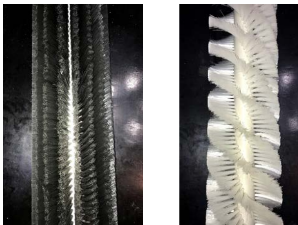
รูปที่ 3.33 แสดงลักษณะแปรงทำความสะอาด แปรงขนเรียงตรง(ซ้าย) แปรงขนเรียงเกลียว(ขวา)
