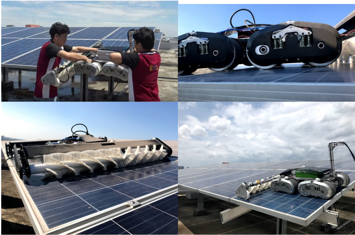
รูปที่ 4.52 การทดสอบการทำงานของหุ่นยนต์แบบ rooftop
