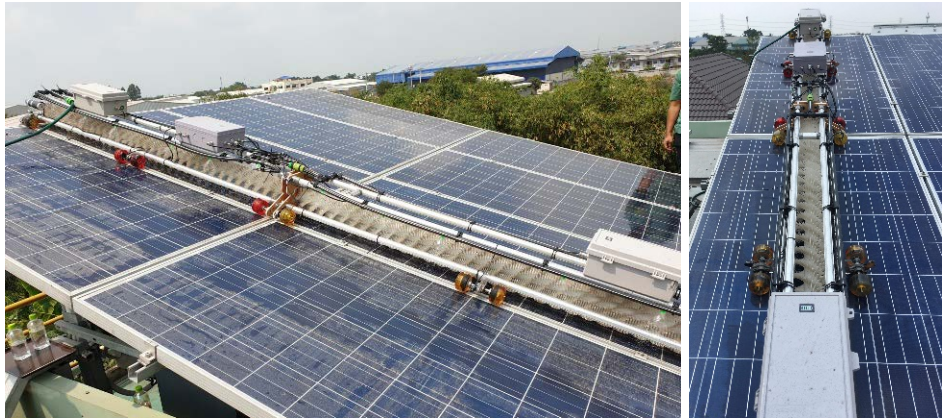
รูปที่ 3.39 แสดงรูปแบบการเชื่อมต่อหุ่นยนต์แบบโมดูลาร์เข้าด้วยกันความยาว 4 เมตร
