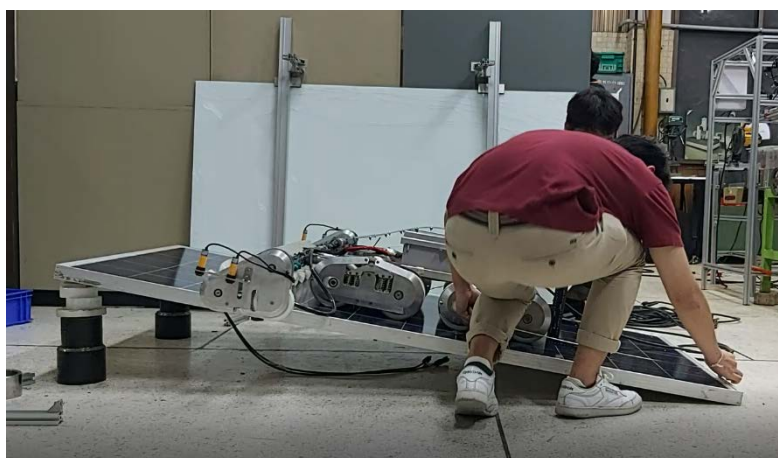
รูปที่ 4.47 ภาพการทดสอบการเคลื่อนที่ของหุ่นยนต์บนแผงเซลล์ที่ชัน 10 องศาในสภาพการทำงานแบบแห้ง
