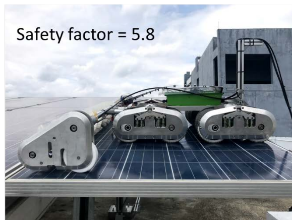
รูปที่ 4.37 การคำนวณ Factor of safety สำหรับป้องกันความเสียหายจากแรงกดทับกระจก
