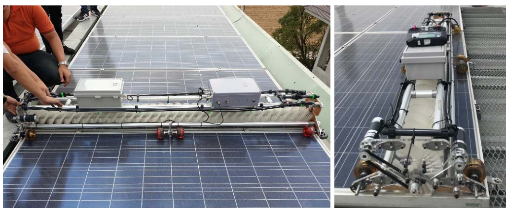
รูปที่ 3.38 การติดตั้งหุ่นยนต์ทำความสะอาดแผงเซลล์พลังงานแสงอาทิตย์ ความกว้าง 2 เมตร
