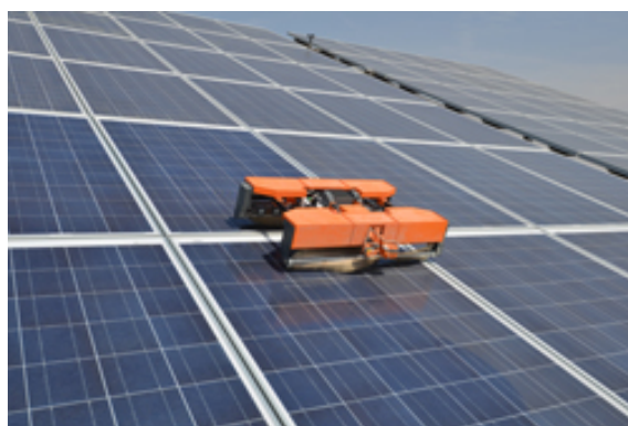
รูปที่ 2.12 หุ่นยนต์ทำความสะอาด SMR-640AD (ที่มา: https://www.jetro.go.jp/en/mjcompany/miraikikai.html )
