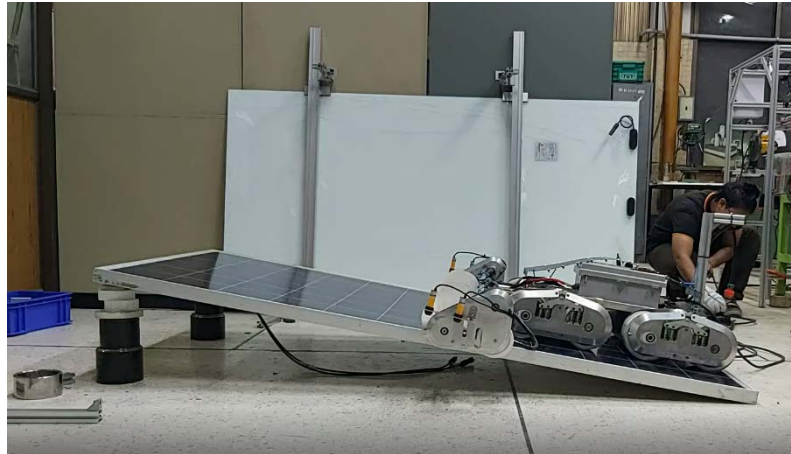
รูปที่ 4.48 ภาพการวัดระยะทางของหุ่นยนต์ที่เคลื่อนที่บนแผงเซลล์ที่ชั้น 10 องศาในสภาพการทำงานแบบแห้ง
