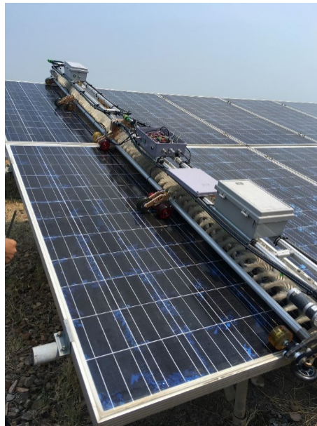
รูปที่ 3.48 แสดงรูปแบบการเชื่อมต่อหุ่นยนต์แบบโมดูลาร์เข้าด้วยกันความยาว 4 เมตร
