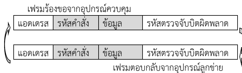
ภาพที่ 2.19 เฟรมการร้องขอ และการตอบกลับบนมอดบัส
