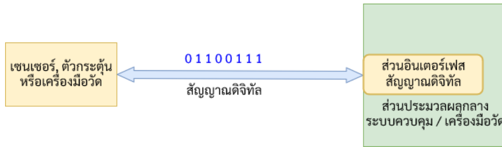
ภาพที่ 2.12 การอินเตอร์เฟสสัญญาณดิจิทัล
