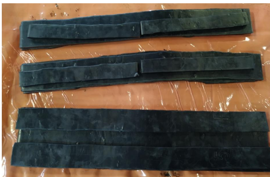
ภาพที่ 44 ยางคอมปาวด์สำหรับแม่พิมพ์บนและล่าง
