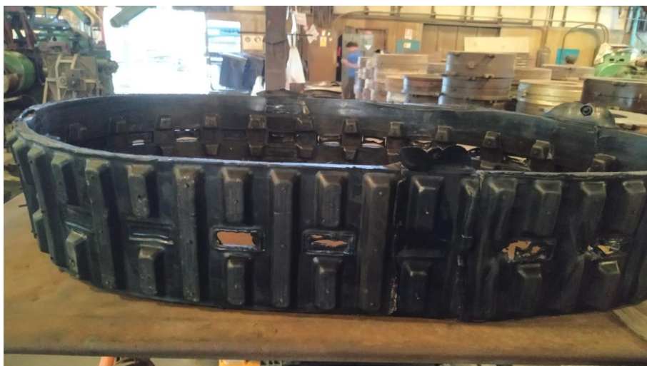
ภาพที่ 51 ยางตีนตะขาบเมื่อทำการประกบกั้นจนครบวง
