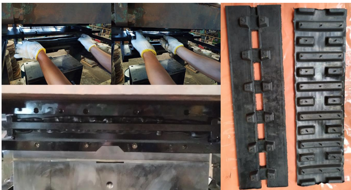
ภาพที่ 6 การอัดขึ้นรูปยางตีนตะขาบ
