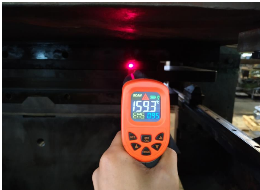
ภาพที่ 43 การทดสอบให้ความร้อนกับแม่พิมพ์
