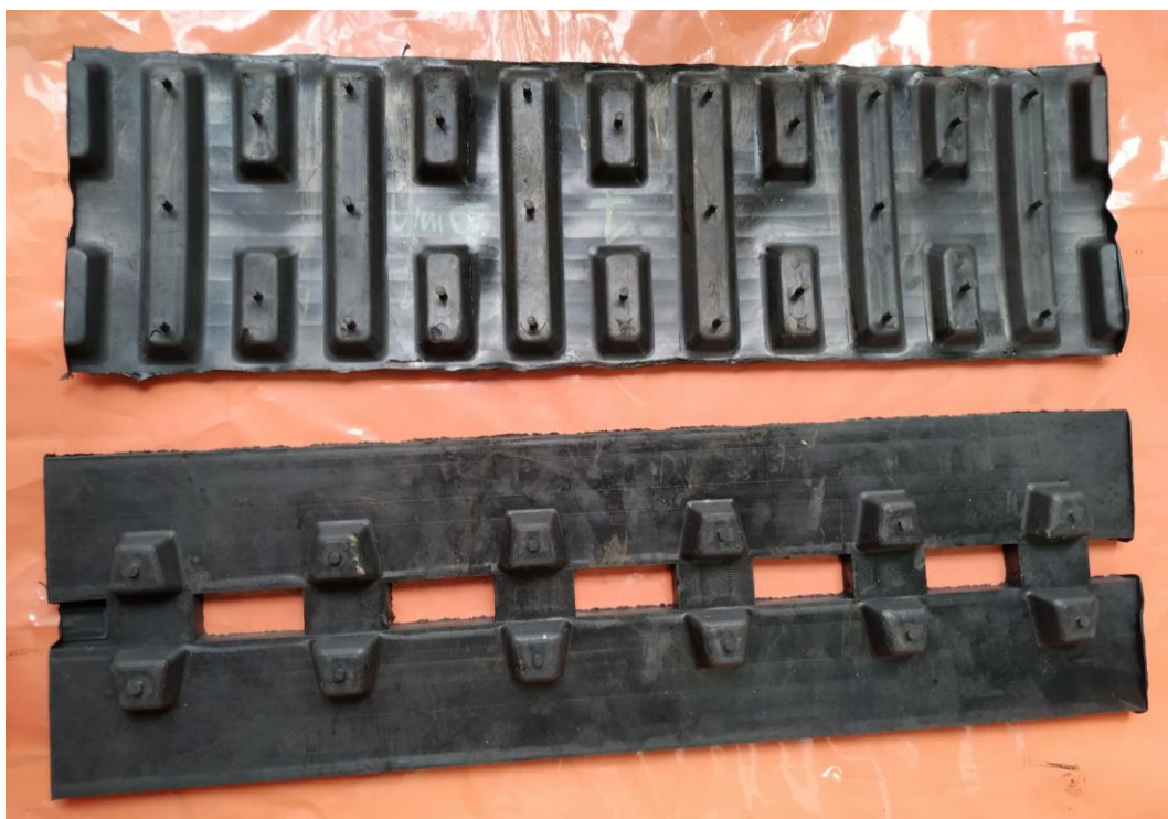
ภาพที่ 47 ชิ้นงานยางดินตะขาบจากการอัดขึ้นรูป
