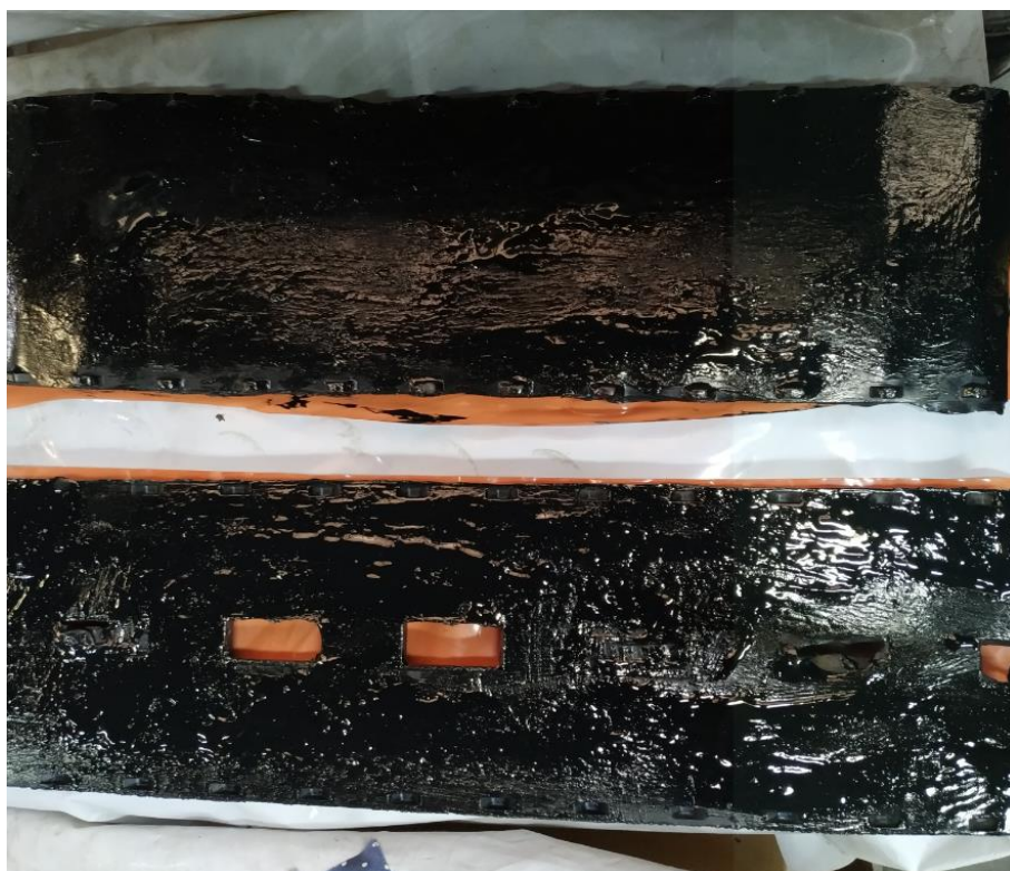
ภาพที่ 48 การทากาวซีเมนต์บนยางในด้านที่ต้องการประกบติดกัน
