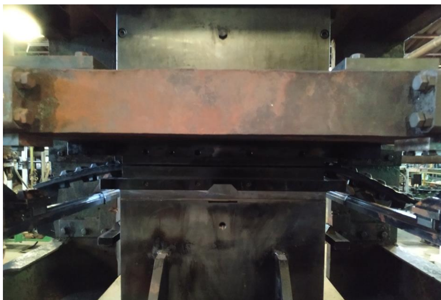
ภาพที่ 50 การอัดประกบติดผ้าใบเข้ากับยางตีนตะขาบ
