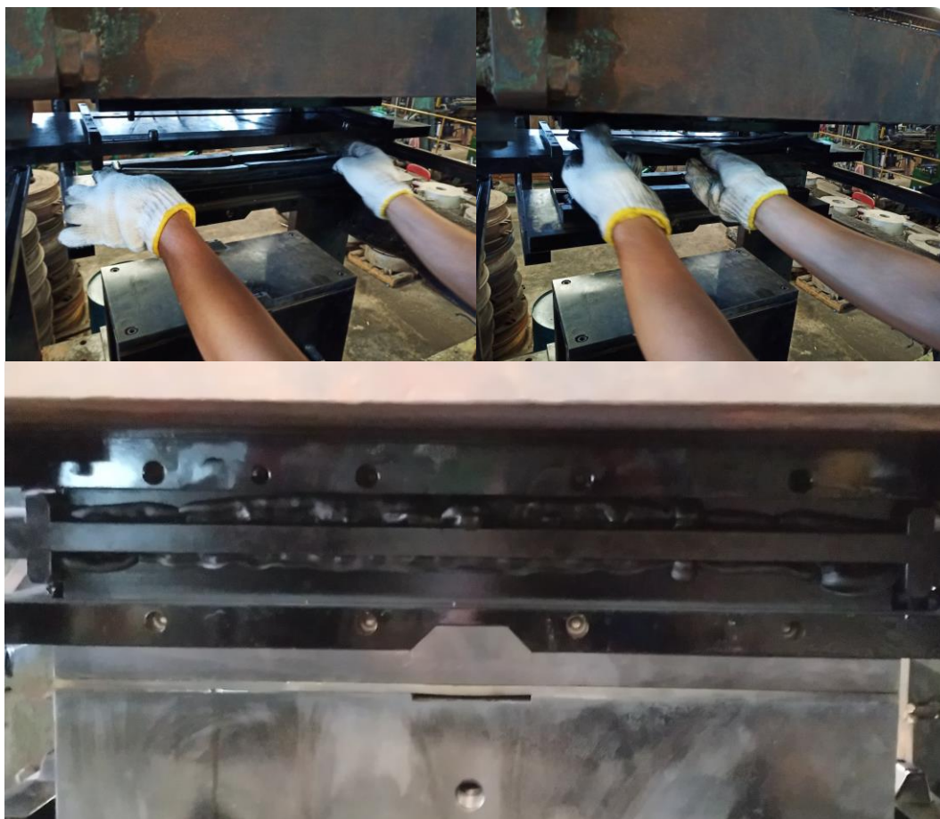
ภาพที่ 46 อัดขึ้นรูปชิ้นยางตีนตะขาบ
