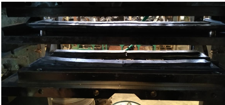
ภาพที่ 45 ยางคอมปาวด์เมื่อนำมาวางเข้ากับแม่พิมพ์
