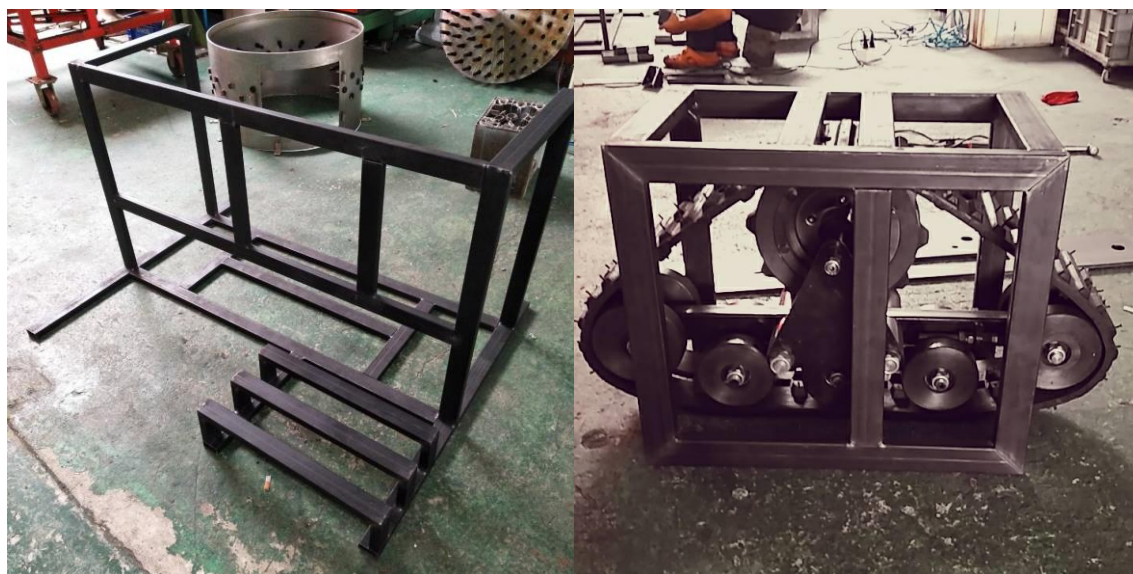
ภาพที่ 53 การเชื่อมประกอบโครงเครื่อง
