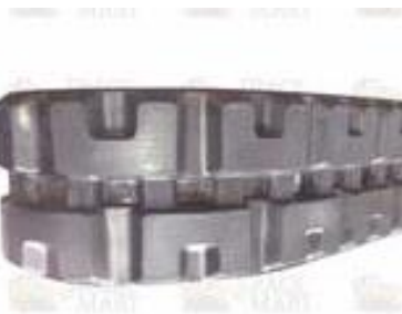
ภาพที่ 7 ดอกยางตีนตะขาแบบ C-Lug [4]
