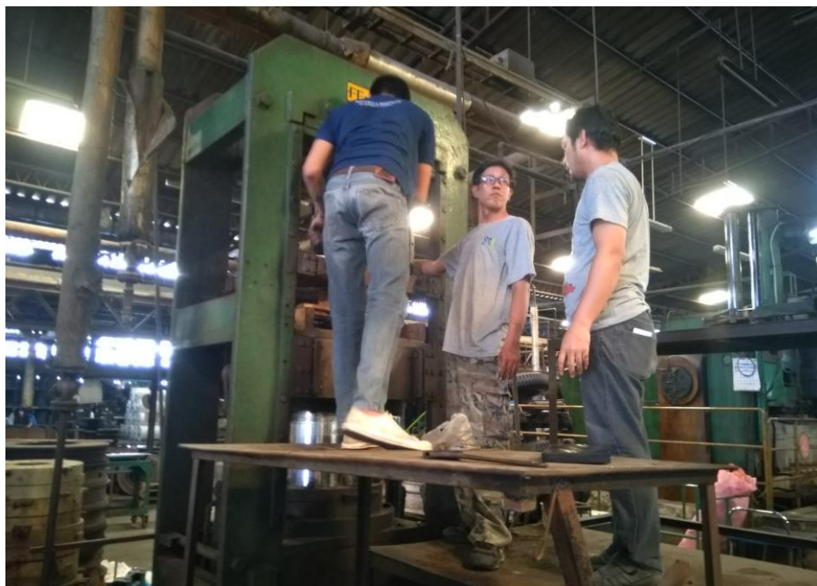
ภาพที่ 39 การประกอบชิ้นส่วนทางกลเข้ากับเครื่องอัดยาง
