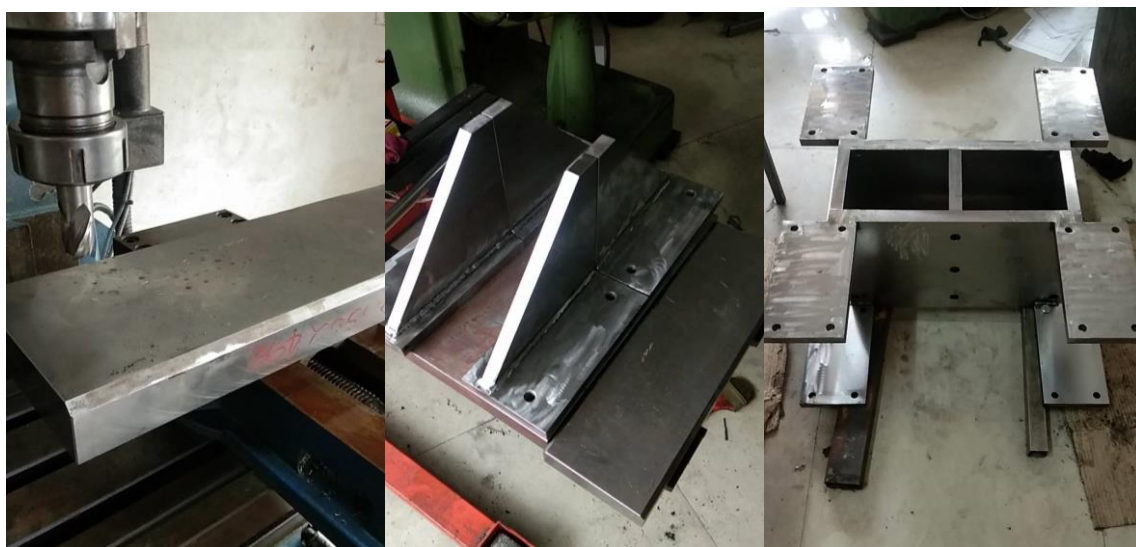
ภาพที่ 38 การผลิตชิ้นส่วนทางกลตามแบบ 3 มิติที่ได้จัดทำขึ้น
