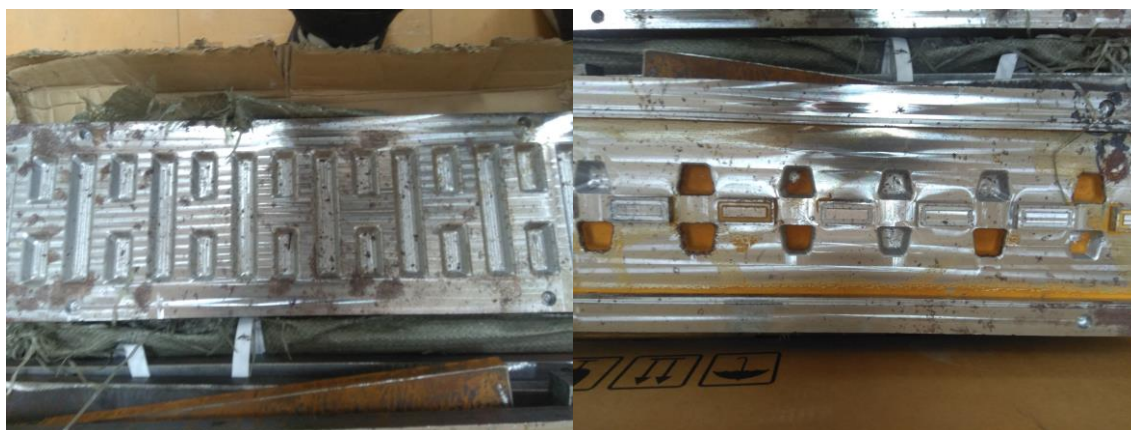
ภาพที่ 3 แม่พิมพ์ขึ้นรูปยางดินตะขาบ
