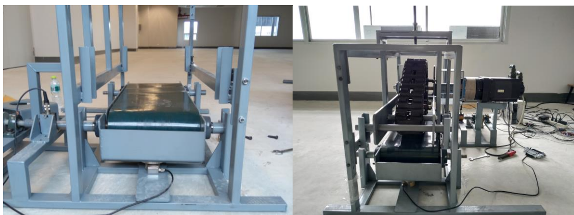
ภาพที่ 55 การติดตั้งเซนเซอร์และระบบไฟฟ้าของเครื่องทดสอบ
