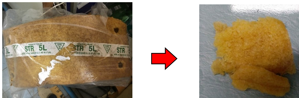
รูปที่ 4.39 การย่อยลดขนาดยางพาราแท่ง STR 5L
