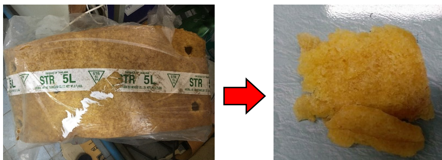
รูปที่ 3.20 การย่อยลดขนาดยางพาราแท่ง STR 5L
