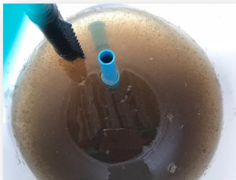
ลักษณะการเกิดตะกอนเมื่อเติมสารตกตะกอน โคโตซานนาโนคอมพอสิต
