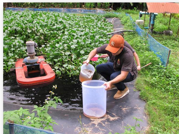
จุดเก็บตัวอย่างน้ำทิ้ง บ่อพักสุดท้ายของระบบบำบัดโรงงาน
