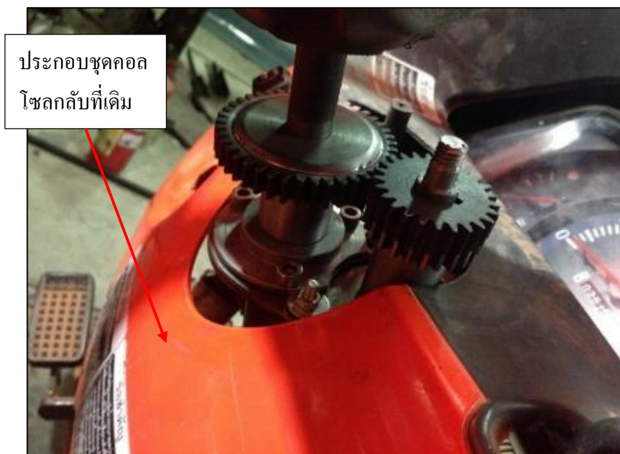
ภาพที่ 65 ติดตั้งชุดคอนโซลเข้าที่เดิม
