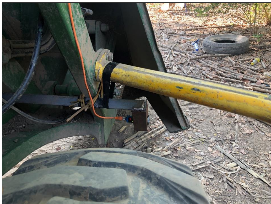
(ข) การติดตั้งเซนเซอร์อัลตราโซนิกบนรถตัดอ้อยที่ตำแหน่งระหว่างชุดโน้มต้นอ้อยกับล้อรถตัดอ้อย
