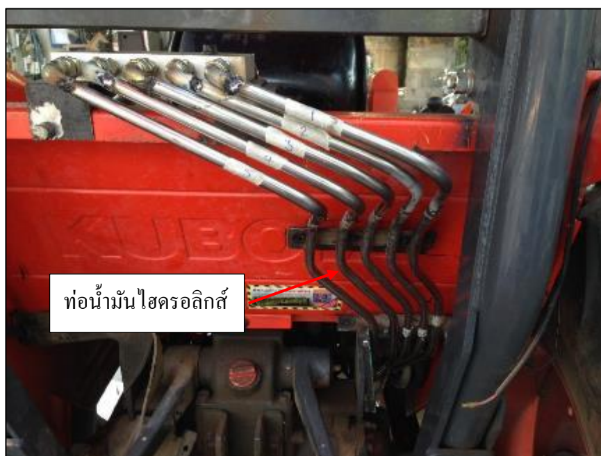
ภาพที่ 139 แสดงถึงการวางท่อไฮดรอลิกส์
