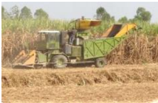
ภาพที่ 3 รถตัดอ้อยที่ท่อนอ้อยไหลลงตะกร้าเหล็กที่วางอยู่ท้ายรถตัดอ้อย (ที่มา: มุลนิธิส่งเสริมวิทยาศาสตร์และเทคโนโลยีในพระบรมราชูปถัมภ์)
