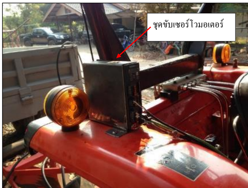
ภาพที่ 64 ตำแหน่งการติดตั้งการส่งกำลังด้วยฟันเฟือง และ ชุดขับ เซอร์โวมอเตอร์
