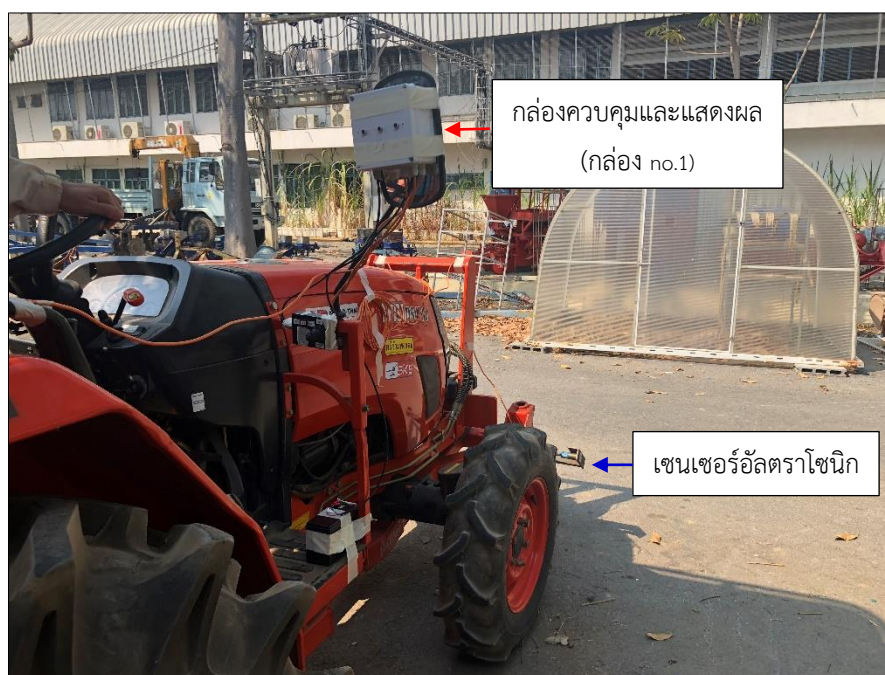
รูปที่ 25 ลักษณะการติดตั้งกล่องควบคุมและแสดงผล (กล่อง no.1) บนรถแทรกเตอร์
