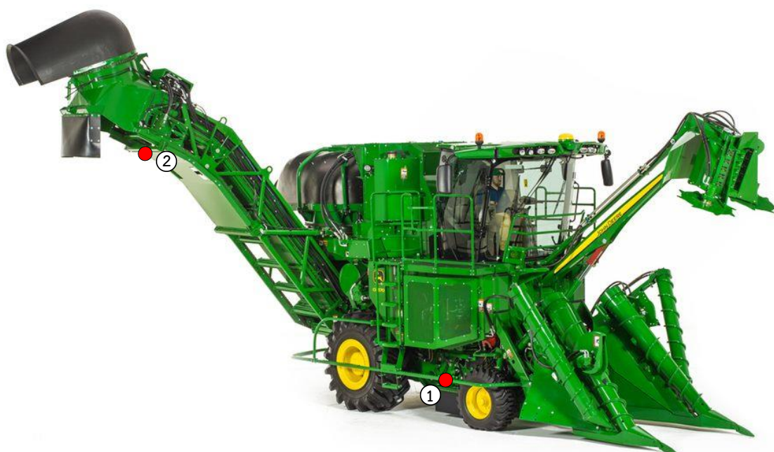
รูปที่ 17 การติดตั้งเซ็นเซอร์อัลตราโซนิกที่ส่วนหน้า (ตำแหน่งที่ 1) และสะพานลำเรียงอ้อย (ตำแหน่งที่ 2)
