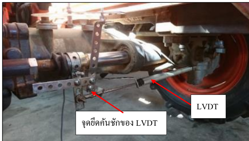
ภาพที่ 89 แสดงการติดตั้ง LVDT
