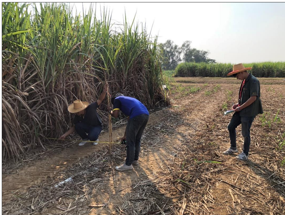
รูปที่ 28 แสดงวิธีการวัดระยะระหว่างแนวต้นอ้อยกับเส้นแสดงแนวการวิ่งของรถแทรกเตอร์ (ระยะ b) ในแต่ละการทดลอง
