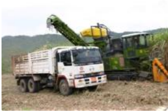
ภาพที่ 2 รถตัดอ้อยที่สับต้นอ้อยแล้วใช้สายพานลำเลียงท่อนอ้อยใส่รถบรรทุก (ที่มา: มุลนิธิส่งเสริมวิทยาศาสตร์และเทคโนโลยีในพระบรมราชูปถัมภ์)
