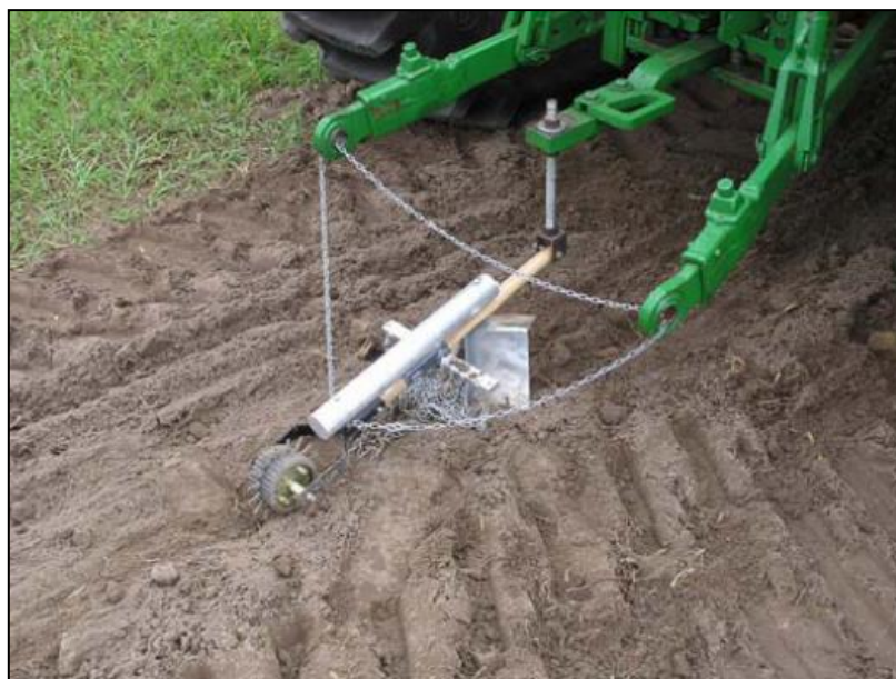
รูปที่ 6 Marker สำหรับทำรอยขีดไปตามแนวการเคลื่อนที่ของรถแทรกเตอร์
