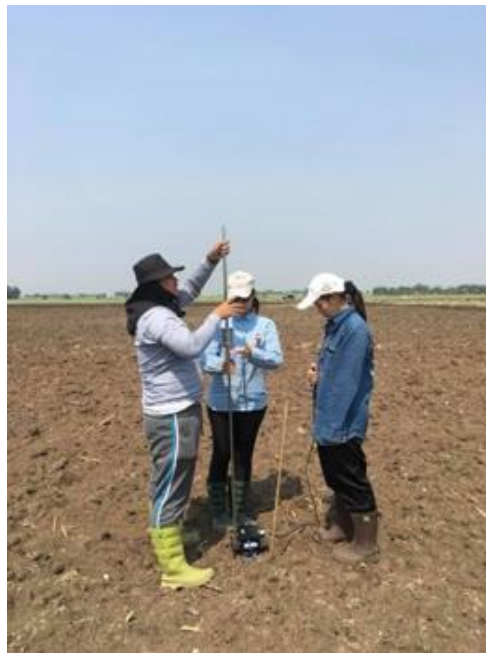
ภาพที่ 28 การเก็บค่าความต้านทานการแทงทะลุของดิน
