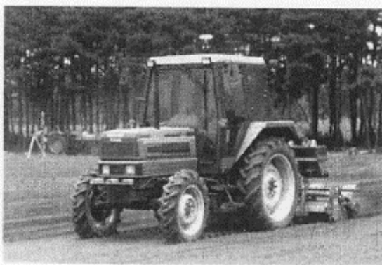
ภาพที่ 24 บอทแทรกเตอร์ใช้ในไร่โดยไม่ต้องใช้คนขับ
