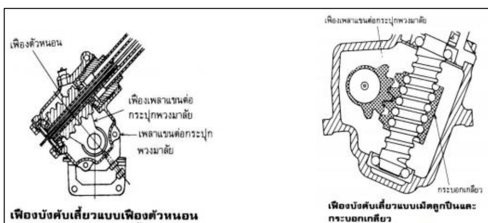
ภาพที่ 44 เฟืองบังคับเลี้ยวแบบเฟืองตัวหนอนและแบบเม็ดลูกป็น
