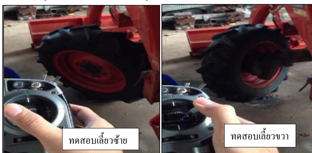
ภาพที่ 100 ทดสอบการควบคุมการเลี้ยวผ่านวิทยุบังคับ
