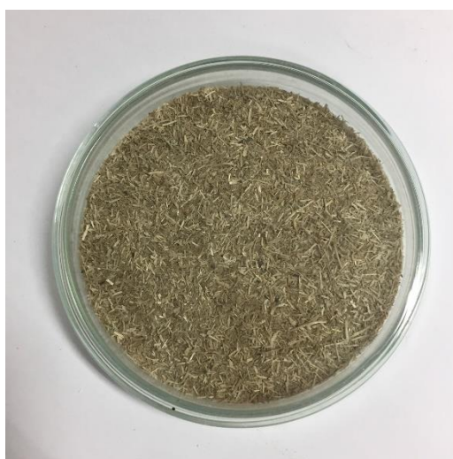
ภาพที่ 8 ชานอ้อยภายหลังบดด้วย Hammer mill
