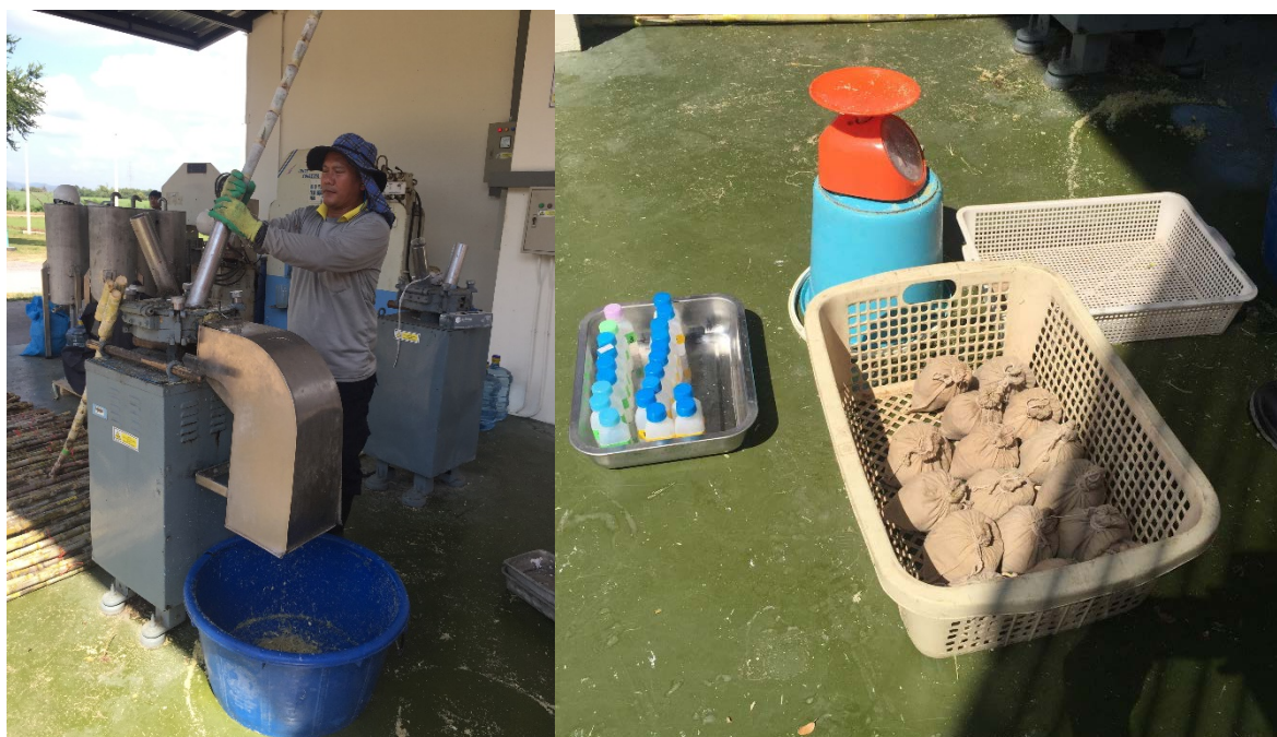
รูปที่ 41 ทำการเก็บข้อมูลความหวานอ้อยที่อายุ 6 เดือน โดยทำการหีบน้ำอ้อยเพื่อหาค่า BRIX Pol %Pol %Fiber %Purity และ CCS และเพื่อนำตัวอย่างน้ำอ้อยไปวิเคราะห์ sugar analysis
