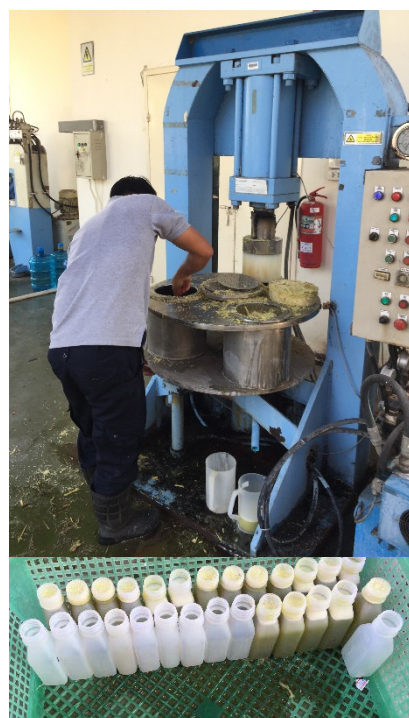
46 เมื่อหีบน้ำอ้อยเพื่อไปวิเคราะห์น้ำตาล
