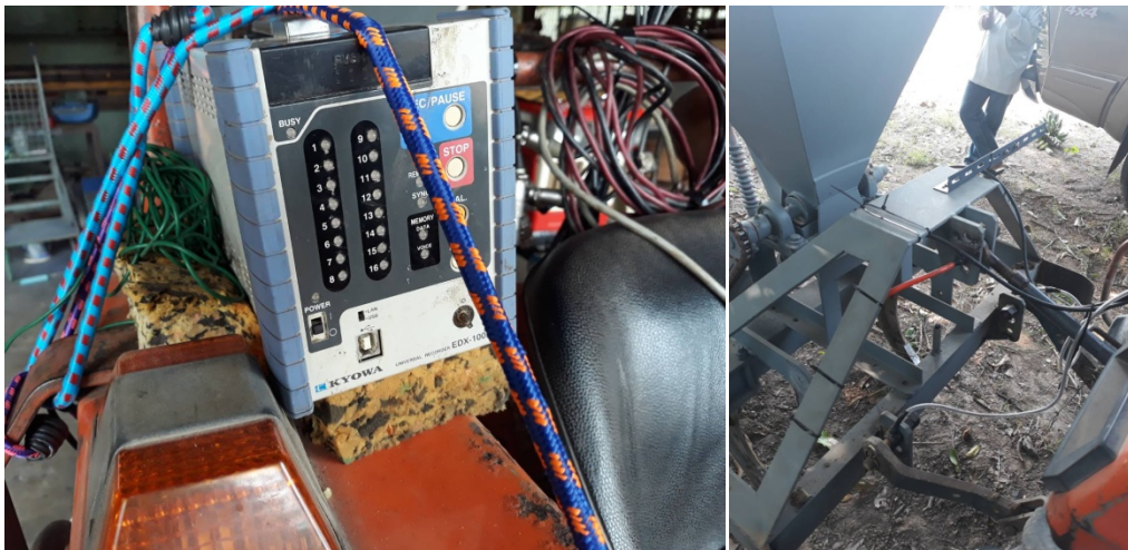
รูปที่ 86 การติดตั้งเครื่องมือสำหรับวัดแรงฉุดลาก
