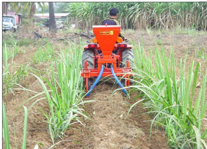
รูปที่ 71 เครื่องฝังกลบปุ๋ยติดท้ายรถแทรกเตอร์ขนาดเล็กของเกษตรกร
