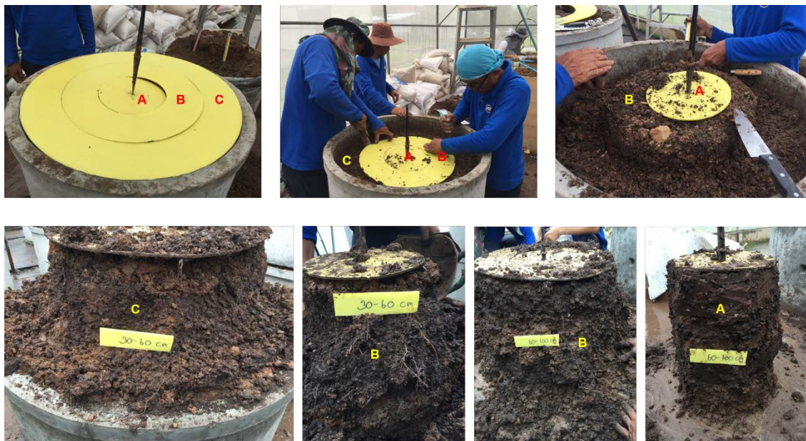
รูปที่ 54 แสดงการเก็บตัวอย่างรากที่ 5 ระดับความลึก คือ 0-10 10-20 20-30 30-60 และ 60-100 ซม. ที่ รศมีแตกต่างกัน คือ 0-12.5 12.5-25 และ 25-37.5 ซึ่งแสดงด้วยตัวอักษร A B และ C ตามลำดับ
