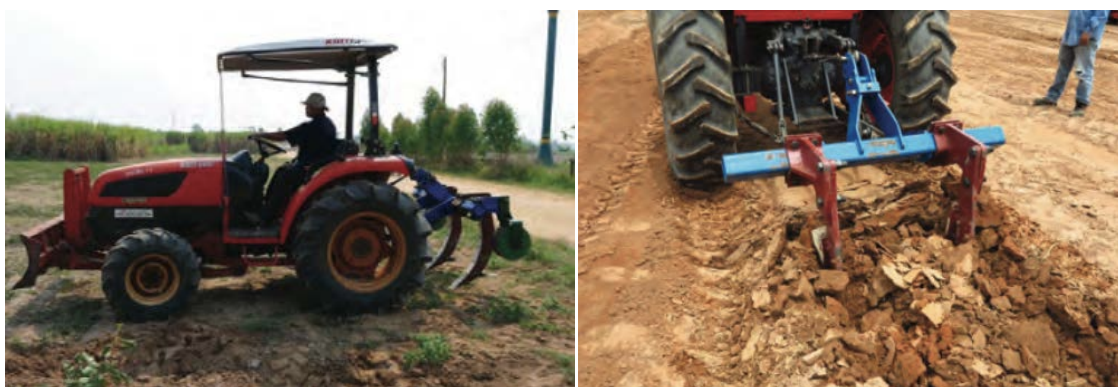
รูปที่ 70 การศึกษาไถระเบิดดินดานติดรถแทรกเตอร์ขนาดกลางสำหรับพื้นที่ปลูกอ้อย (ที่มา: ยุทธนา เครือหาญชาญพงศ์ และคณะ, 2560)
