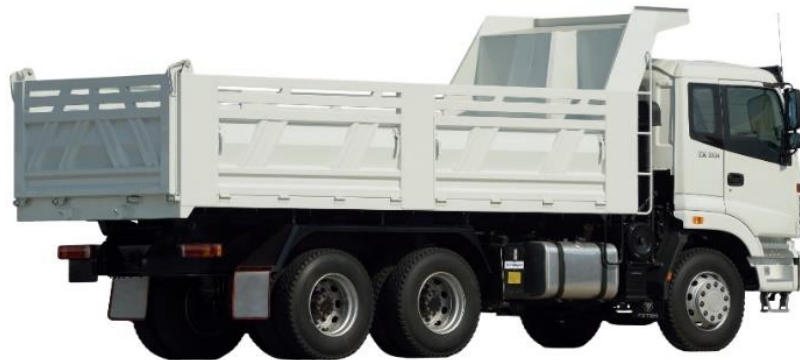
รูปที่ 4.1-7 รถบรรทุกที่มี 3 เพลา 6 ล้อ ยาง 10เส้น [1]
