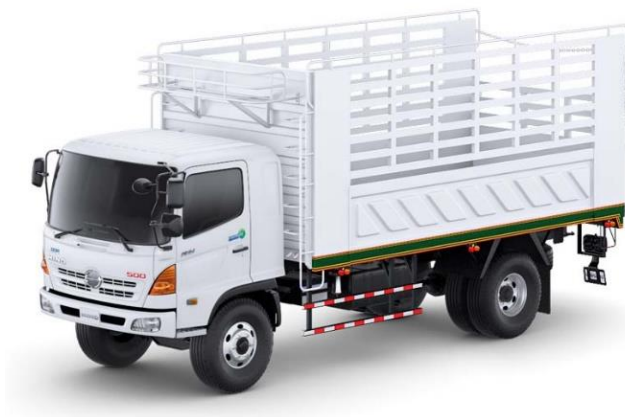
รูปที่ 4.1-6 รถบรรทุกที่มี 2 เพลา 4 ล้อ ยาง 6 เส้น [1]
