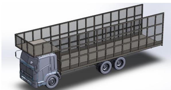
รูปที่ 7.1-7 การปรับปรุงตะกร้ารถบรรทุกสลิบล้อแบบตะแกรง
