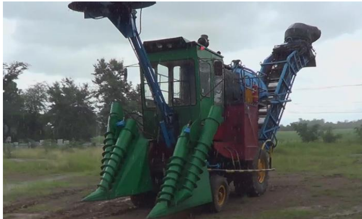
รูปที่ 6.1-2 รถตัดอ้อยไร่คนขับประดิษฐ์โดยคนไทย (ที่มา www.sanook.com )
