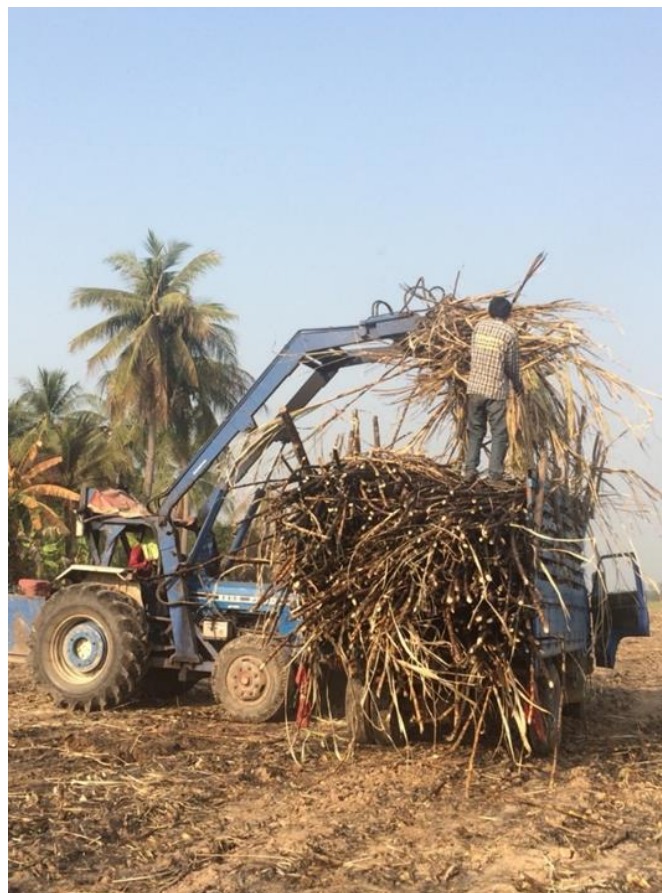
รูปที่ 4.1-16 การลำเลียงอ้อยในรถบรรทุกด้วยรถคีบ ที่มา: โรงงานพิษณุโลก
