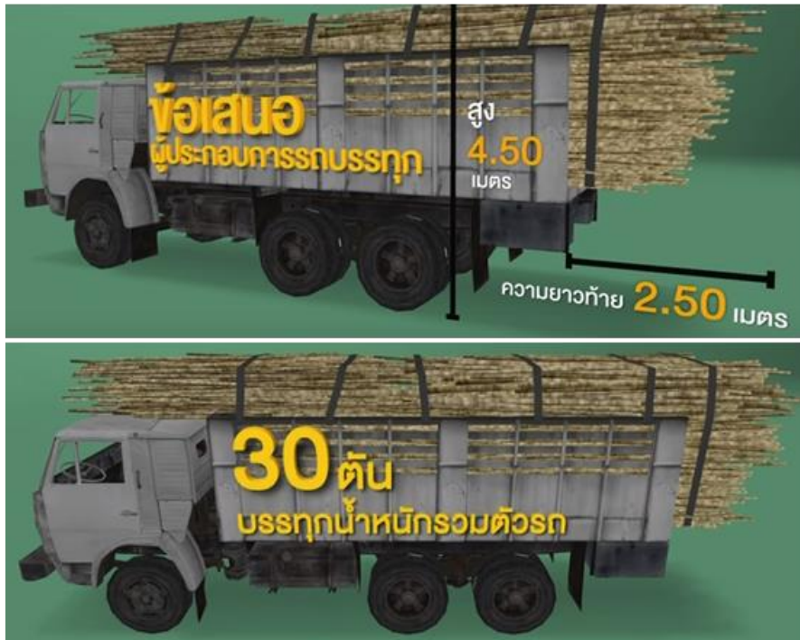
รูปที่ 2.2-5 ข้อเสนอทางด้านขนาดและน้ำหนักบรรทุกอ้อยของผู้ประกอบการบรรทุกอ้อย
