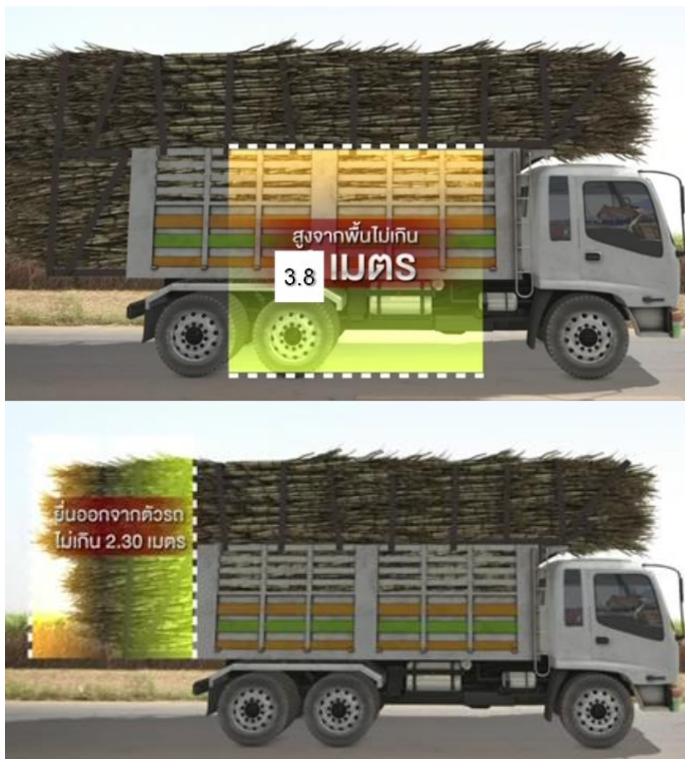
รูปที่ 2.2-1 ลักษณะการบรรทุกอ้อยขนส่งเข้าสู่โรงงานน้ำตาล
