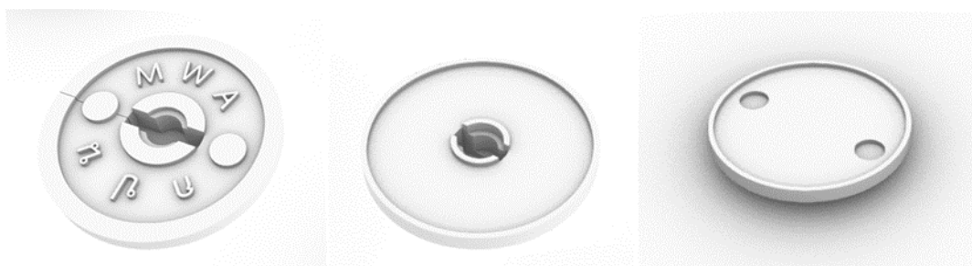
ภาพที่ 3-47 ภาพจำลองแบบฝาห่อแบบมาตรฐาน (ซ้าย) แบบปรับปรุงลดขนาด (กลาง) แบบปรับปรุงเปลี่ยนวิธีการเปิด (ขวา)
