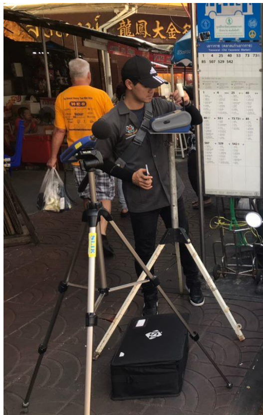
ภาพที่ 3-36 การติดตั้งเครื่องมือวัดมลภาวะเสียง (อุปกรณ์ทางฝั่งซ้าย) และเครื่องมือวัดมลภาวะทางอากาศ (อุปกรณ์ทางฝั่งขวา) ในแต่ละจุด
