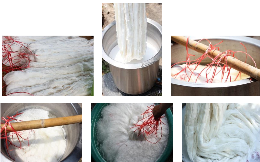
ภาพที่ 2.12 การทำความสะอาดเส้นด้าย
