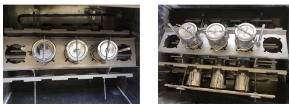
ภาพที่ 3.32 การทดสอบการซัก (Laundering device)
