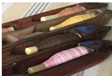
ภาพที่ 3.45 การเตรียมเส้นพุ่ง
