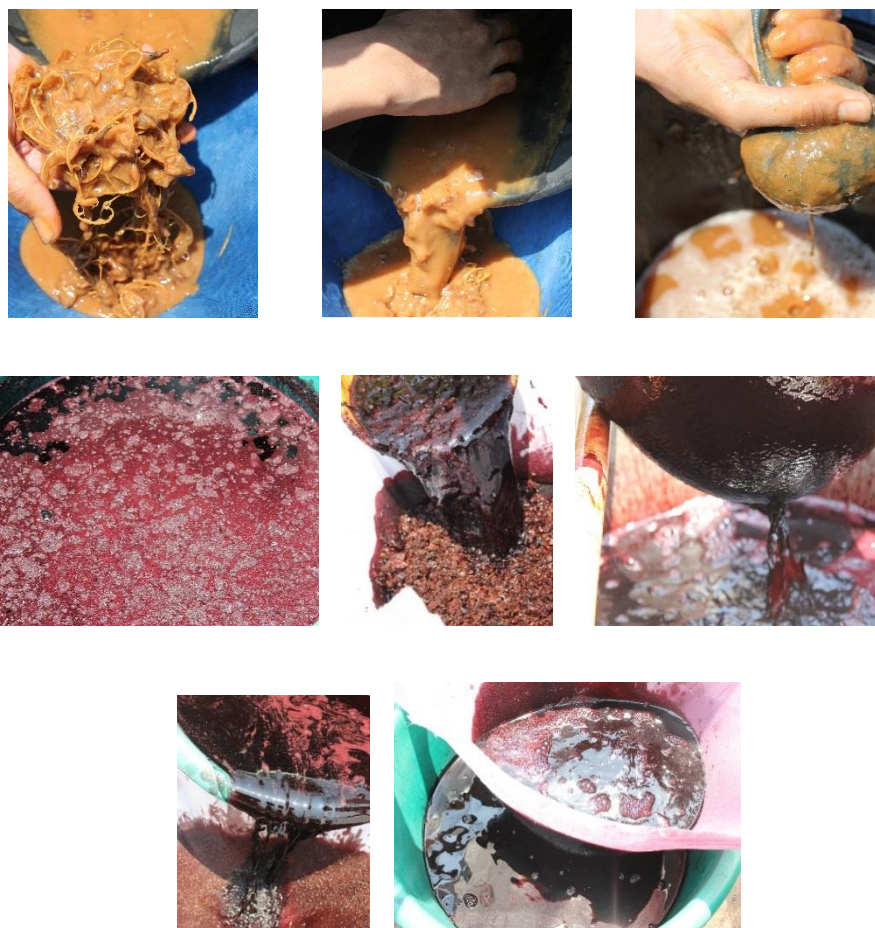
ภาพที่ 3.15 วิธีการสกัดสีจากครั่ง
