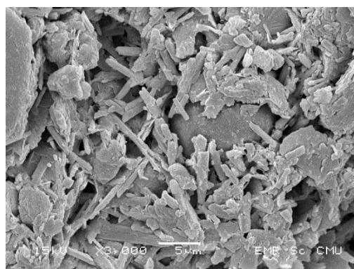
ภาพ 4.17 ลักษณะรูพรุนในเนื้อเซรามิกปูนปลาสเตอร์ผสมกาฐสูตร 5PLC + 10G
