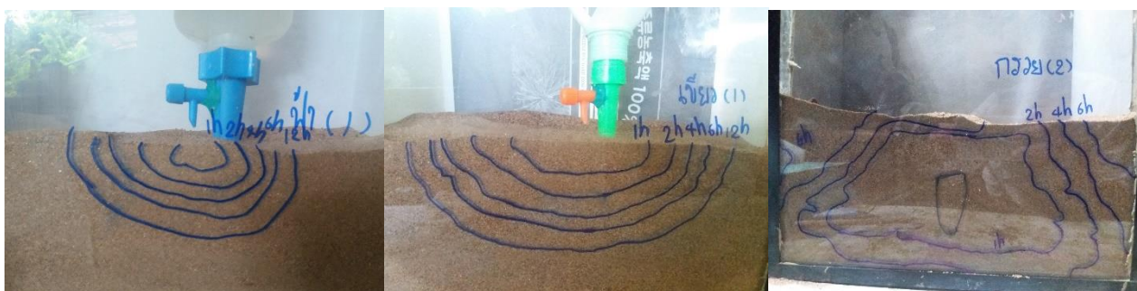
ภาพ 4.5 รูปแบบการแพร่ของน้ำในทรายละเอียดของผลิตภัณฑ์ให้น้ำแก่พืชทั้ง 3 ชนิด
