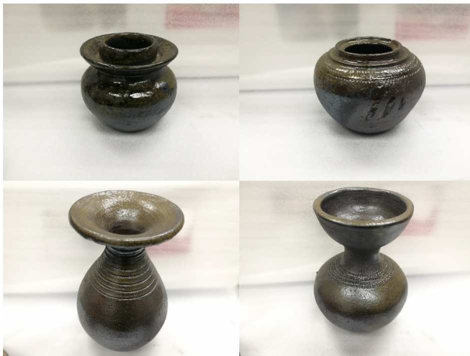
ภาพที่ 4.17 ตัวอย่างผลิตภัณฑ์เครื่องปั้นดินเผาผ่านกระบวนการเคลือบด้วยเคลือบซีเมนต์ผ่านกระบวนการเผาด้วยเตาพื้น
