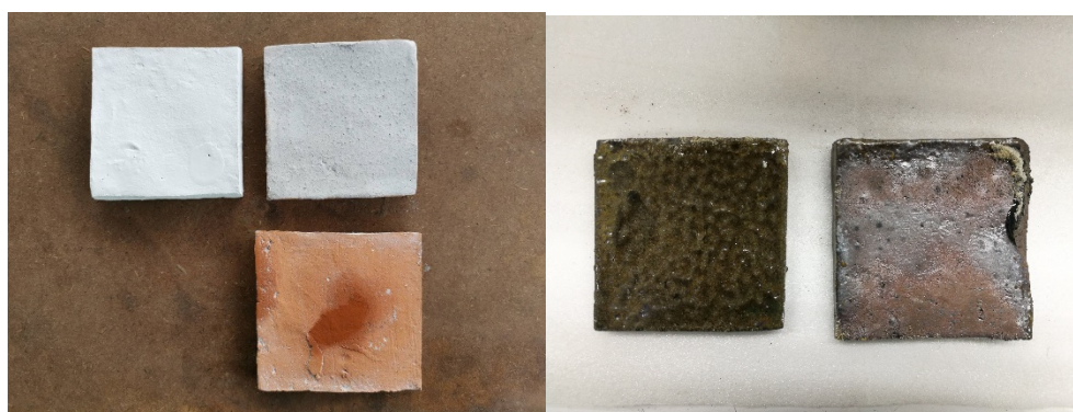
ภาพที่ 4.15 การทดลองเคลือบบนเนื้อดินด่านเกวียนเพื่อหาวิธีการเลียนแบบผลิตภัณฑ์เครื่องปั้นดินเผาด่านเกวียนในอดีต
