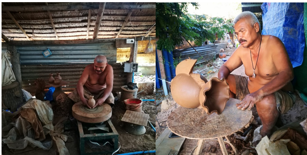
ภาพที่ 4.19 การขึ้นรูปผลิตภัณฑ์ตามมาตรฐาน GI ด้วยพะมอนหรือแป้นเหล็ก
