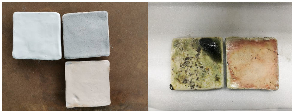
ภาพที่ 4.14 การทดลองเคลือบบนเนื้อดินสำเร็จรูปเพื่อหาวิธีการเลียนแบบผลิตภัณฑ์เครื่องปั้นดินเผาด่านเกวียนในอดีต
