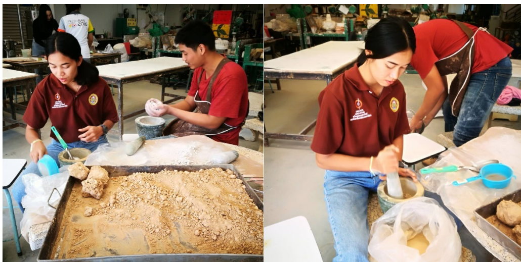
ภาพที่ 4.18 การบดดินและร้อนผ่านตะแกรง ความละเอียด 80 เมช
