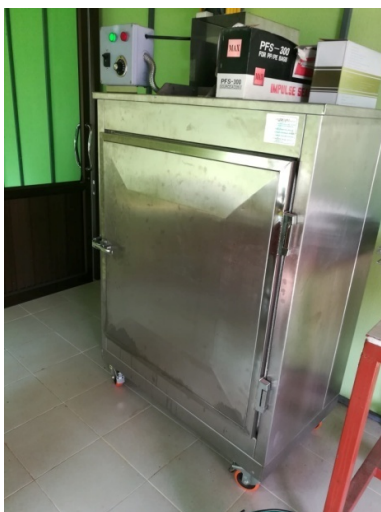
ภาพที่ 4.10 การอบผลดิบแมคคาเดเมียด้วยพลังงานแก๊ส
