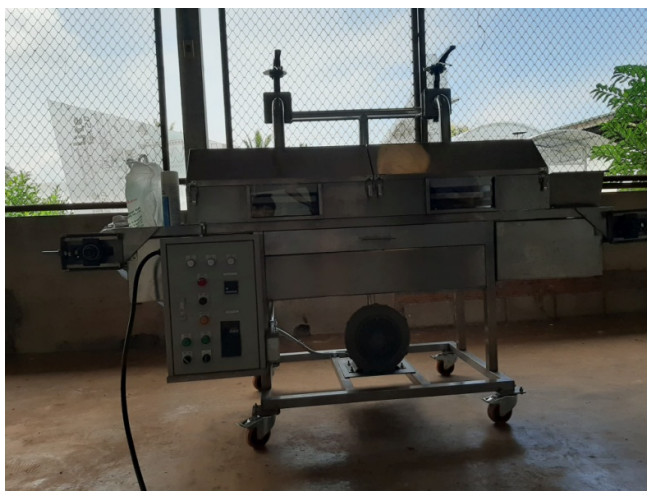
ภาพที่ 4.20 ผลการสร้างเครื่องอบแห้งเนื้อกล้วยแมคคาเดเมียด้วยอินฟราเรดแบบสายพาน
