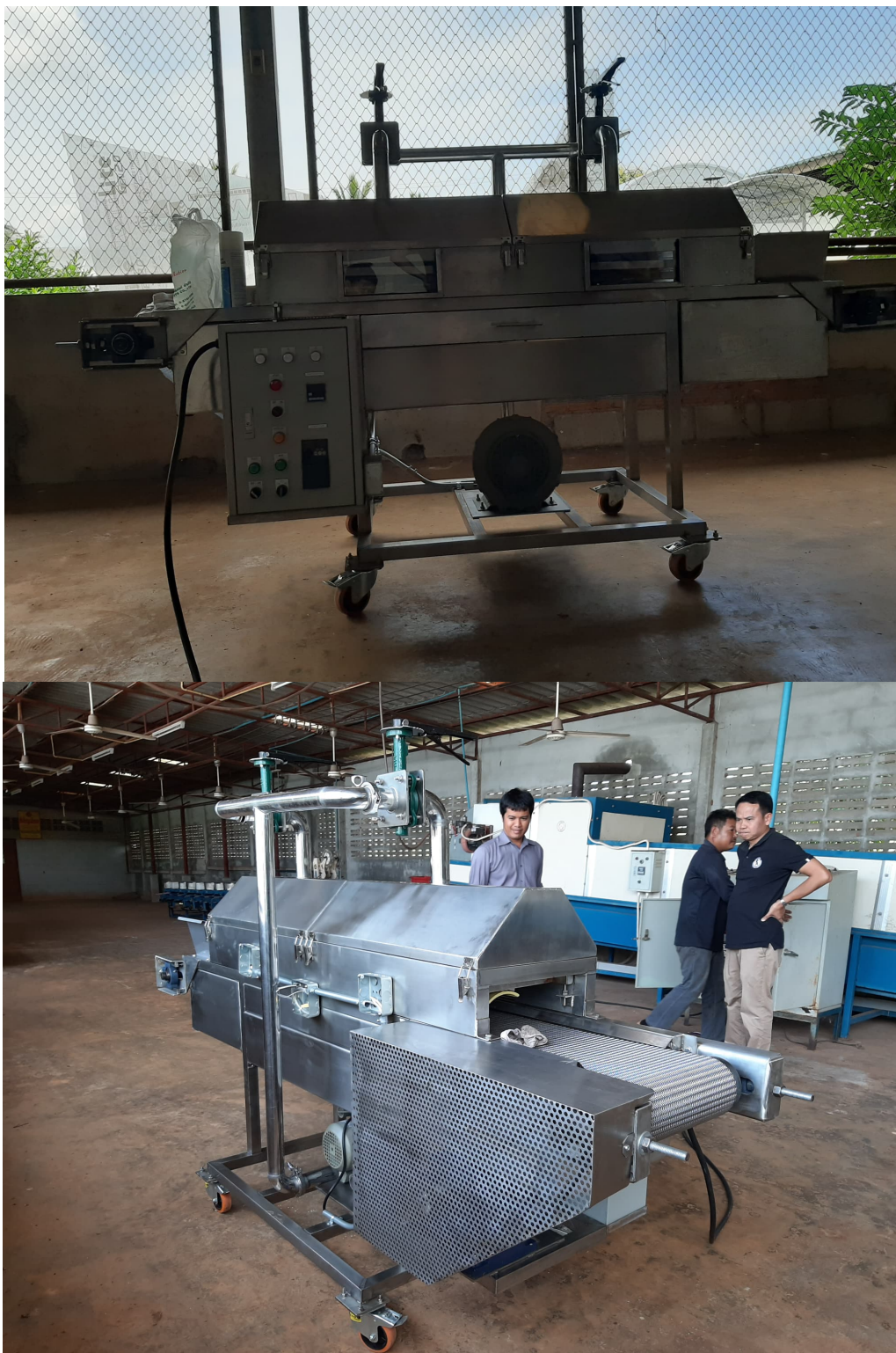
ภาพที่ ค.5 การพัฒนาเทคโนโลยีเครื่องอบแห้งเนื้อถั่วแมคคาเดเมียด้วยอินฟราเรดแบบสายพาน
