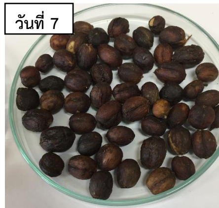
รูปที่ 2.36 ตัวอย่างกาแฟในระหว่างการอบด้วยเครื่องอบพลังงานแสงอาทิตย์ (45 องศาเซลเซียส ในช่วง 72 ชั่วโมงแรก แล้วลดอุณหภูมิเหลือ 30 องศาเซลเซียส)
