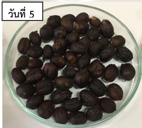
รูปที่ 2.36 ตัวอย่างกาแฟในระหว่างการอบด้วยเครื่องอบพลังงานแสงอาทิตย์ (45 องศาเซลเซียส ในช่วง 72 ชั่วโมงแรก แล้วลดอุณหภูมิเหลือ 30 องศาเซลเซียส)
