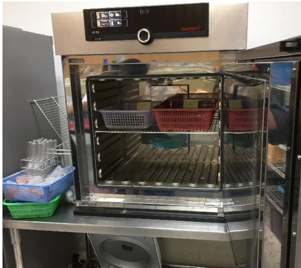
รูปที่ 2.3 การอบผลกาแฟที่อุณหภูมิในการอบที่ 45 องศาเซลเซียส และควบคุมความเร็วลมที่ 80 เปอร์เซนต์
