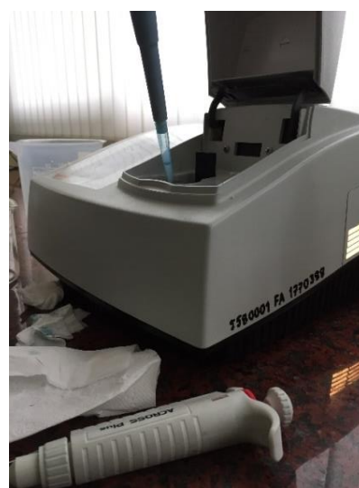
รูปที่ 2.7 การวิเคราะห์ผลการสกัดด้วยเครื่องสเปกโทรโฟโตมิเตอร์ (spectrophotometer)
