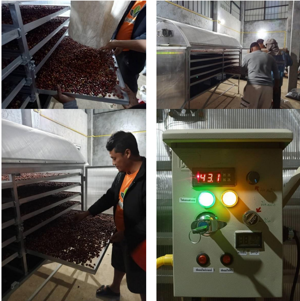
รูปที่ 2.33 ชาวบ้านสามารถทำการอบผลสดเชอร์รี่กาแฟด้วยตู้อบพลังงานแสงอาทิตย์ได้ด้วยตนเองในวันที่ 14 พฤศจิกายน 2562 โดยใช้อุณหภูมิ 45 องศาเซลเซียส และตั้งค่าอุณหภูมิสำหรับระบบควบคุมอัตโนมัติไว้ที่ไม่เกิน 50 องศาเซลเซียส และลดอุณหภูมิเหลือ 30 องศาเซลเซียส อบต่ออีกเป็นเวลา 4 วัน
