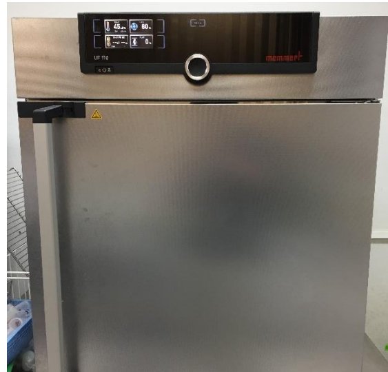
รูปที่ 2.3 การอบผลกาแฟที่อุณหภูมิในการอบที่ 45 องศาเซลเซียส และควบคุมความเร็วลมที่ 80 เปอร์เซนต์
