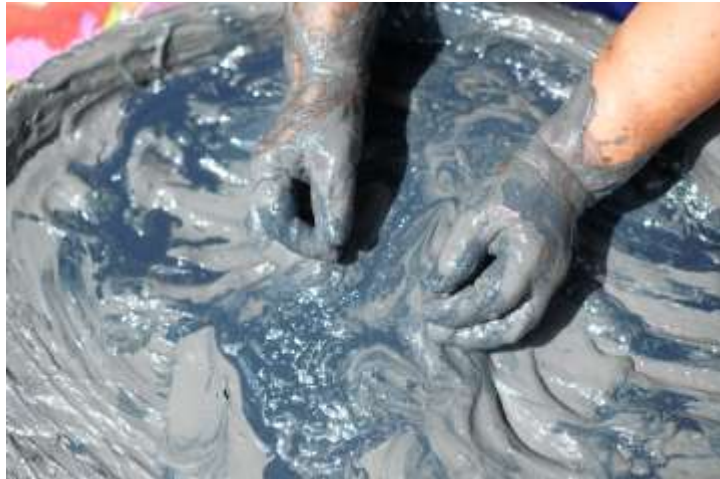
ภาพที่ 4.5 กระบวนการนวดดินโคลนครามบ้านเชียง
