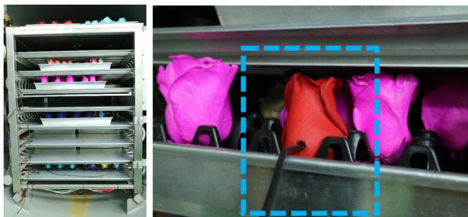
ภาพที่ 3.9 การวางตัวอย่างภายในห้องอบแห้ง และการเสียบโพรบเพื่อวัดอุณหภูมิใจกลางตัวอย่าง
