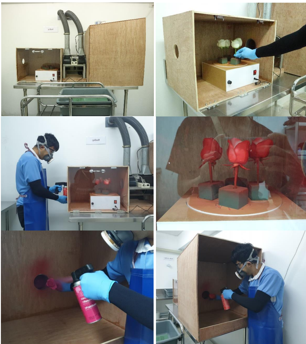
ภาพที่ 4.12 ต้นแบบ และการใช้งานตู้พ่นสีรุ่น 2
