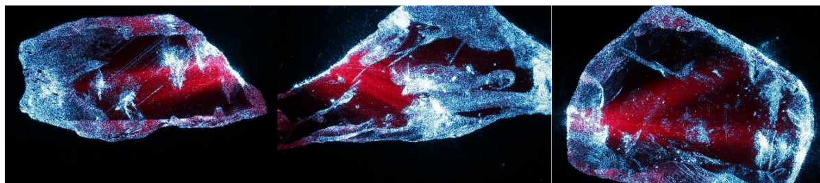
ภาพที่ 4-31 ผลการวิเคราะห์ Laser-Tomography ของทับทิม จากแหล่งโมซัมบิก
