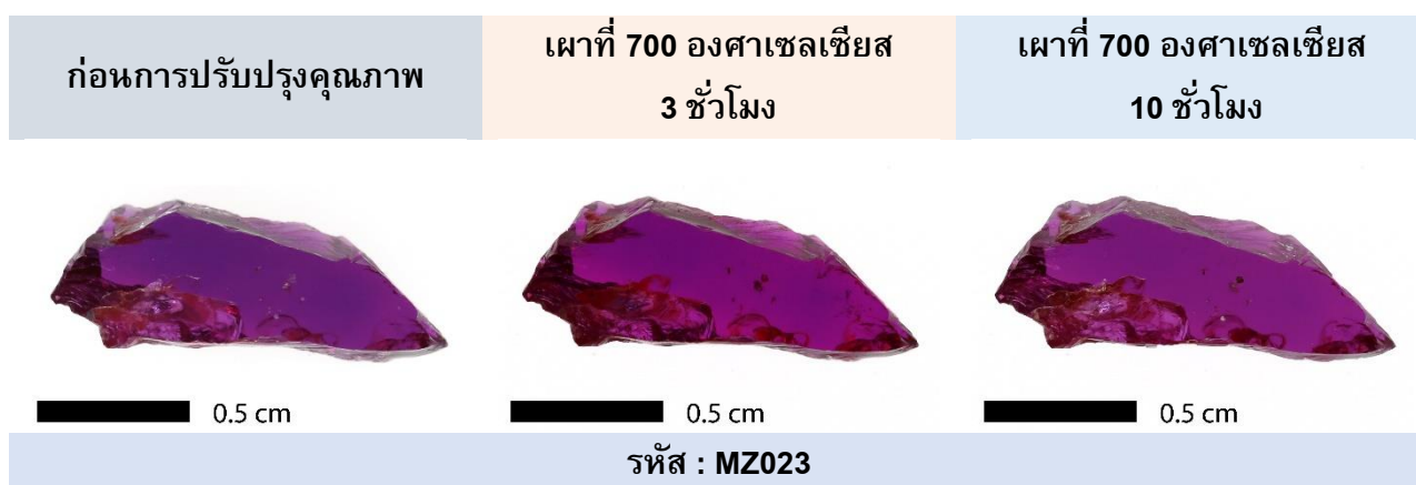
ภาพที่ 4-36 ทับทิมก่อน-หลังเผาที่อุณหภูมิ 700 องศาเซลเซียส 3 และ 10 ชั่วโมง พบว่าจำสีน้ำเงินลดลงหลังการเผาตามลำดับ
