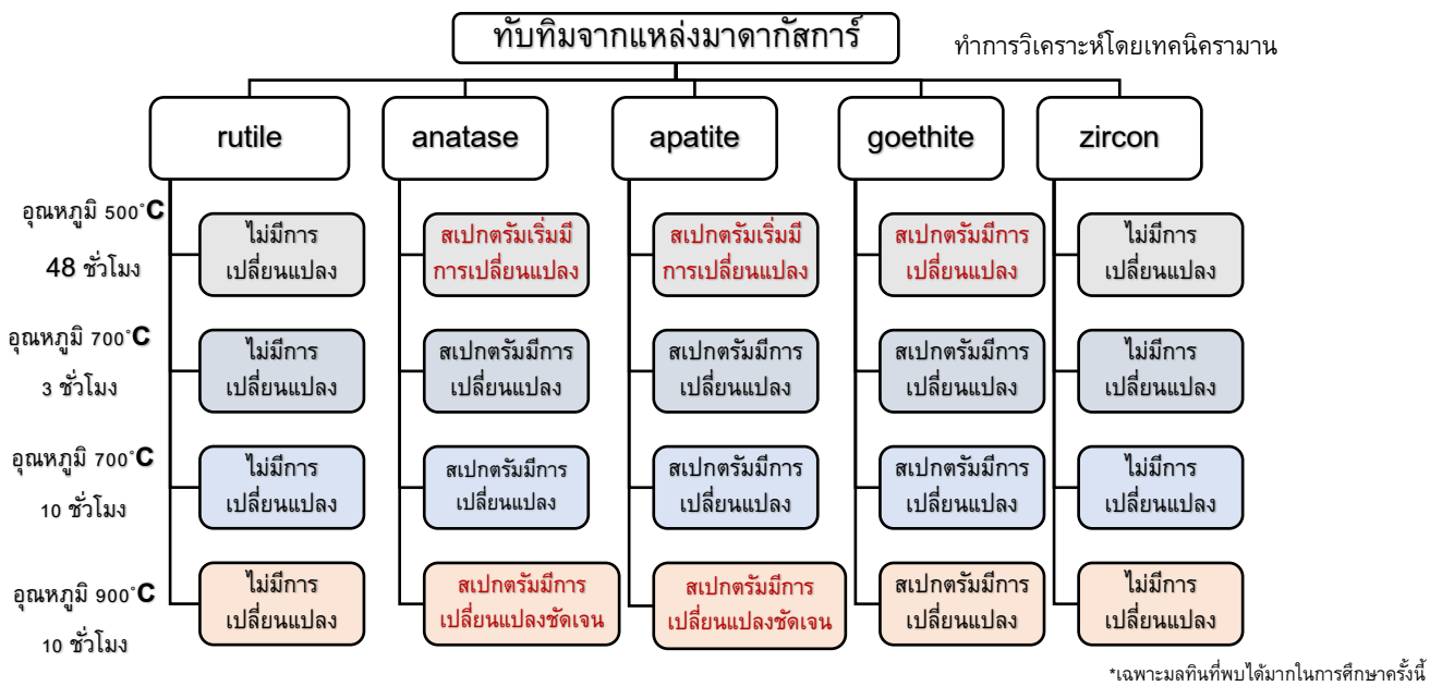
ภาพที่ 5-3 ผลการเปลี่ยนแปลงรามานสเปกตรัมของมลทินในทับทิมจากแหล่งมาดากัสการ์ที่อุณหภูมิต่างๆ
