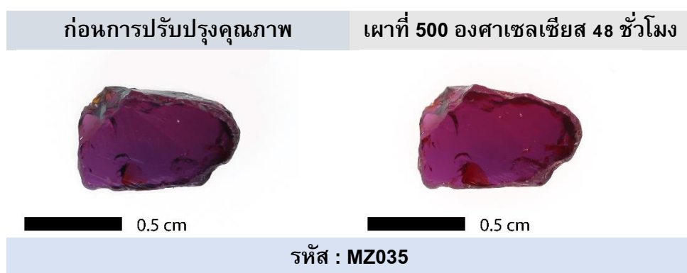
ภาพที่ 4-35 ทับทิมก่อน-หลังเผาที่อุณหภูมิ 500 องศาเซลเซียส 48 ชั่วโมง พบว่ามีการลดลงของจำสีน้ำเงินเล็กน้อย
