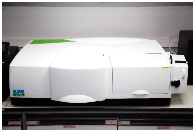
ภาพที่ 3-2 เครื่อง UV-Vis-NIR spectrophotometer รุ่น LAMBDA 1050
