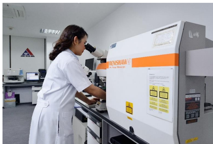
ภาพที่ 3-5 เครื่อง Raman spectroscope รุ่น InVia Raman
