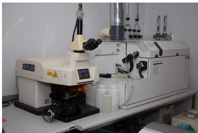
ภาพที่ 3-6 เครื่อง LA-ICP-MS
