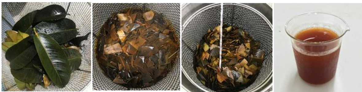
ภาพที่ 4.5 แสดงการสกัดสีจากใบมังคุด เริ่มจากล้างทำความสะอาดมังคุด นำใบมังคุดไปหั่นให้เป็นชิ้นเล็ก ต้มสกัดสีที่ 90°C 90 นาที และ สารสกัดสีจากใบมังคุด เรียงจากซ้ายไปขวา
