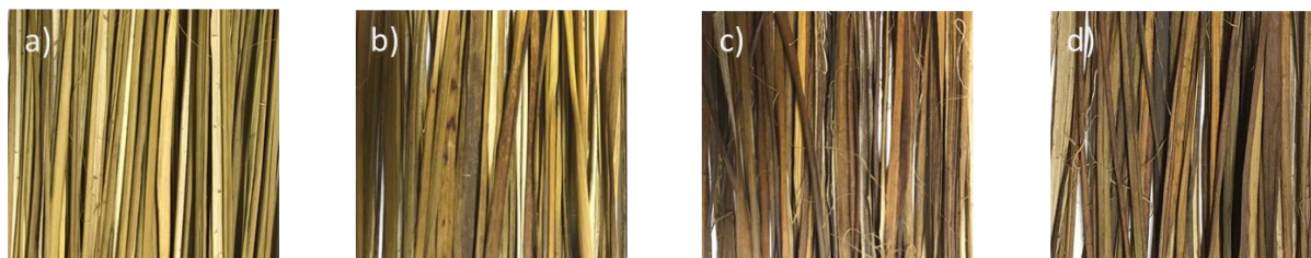
ภาพที่ 4.1 เส้นใยกกที่ผ่านการฟอกผิวด้วยสารละลายโซเดียมไฮดรอกไซด์ (NaOH) ความเข้มข้นโดยน้ำหนัก (w/w) ร้อยละ a) 0.1, b) 0.2, c) 0.3, d) 0.4
