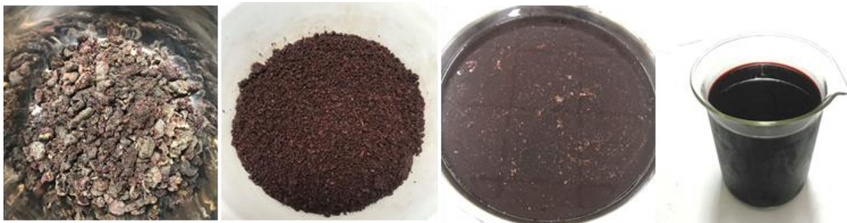
ภาพที่ 4.4 แสดงการสกัดสีจากครั้ง เริ่มจากรังครั้ง ล้างทำความสะอาดแล้วนำไปบดด้วยเครื่องบดไฟฟ้า ต้มสกัดสีที่ 90°C 30 นาที และ สารสกัดสีจากครั้ง เรียงจากซ้ายไปขวา
