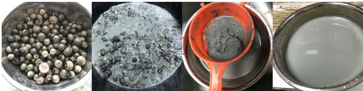
ภาพที่ 4.3 แสดงการสกัดสีจากผลมะเกลือ(ตองด้วยน้ำ) ผลมะเกลือตำและแช่ในน้ำ กรองเอากากออก และสารสกัดสีจากผลมะเกลือ เรียงจากซ้ายไปขวา
