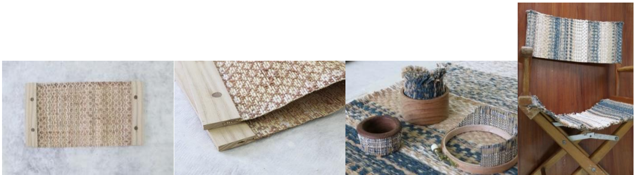
ภาพที่ 5.13 ตัวอย่างการทดลองขึ้นรูปผลิตภัณฑ์ด้วยการเย็บ การติดซิป การลามีเนตด้วยแผ่นหนัง แผ่นเปลือก ลำต้นกล้วย การชิงตริงบนที่นั่ง การเย็บหุ้มขอบ การปิดขอบด้วยมือจับไม้
