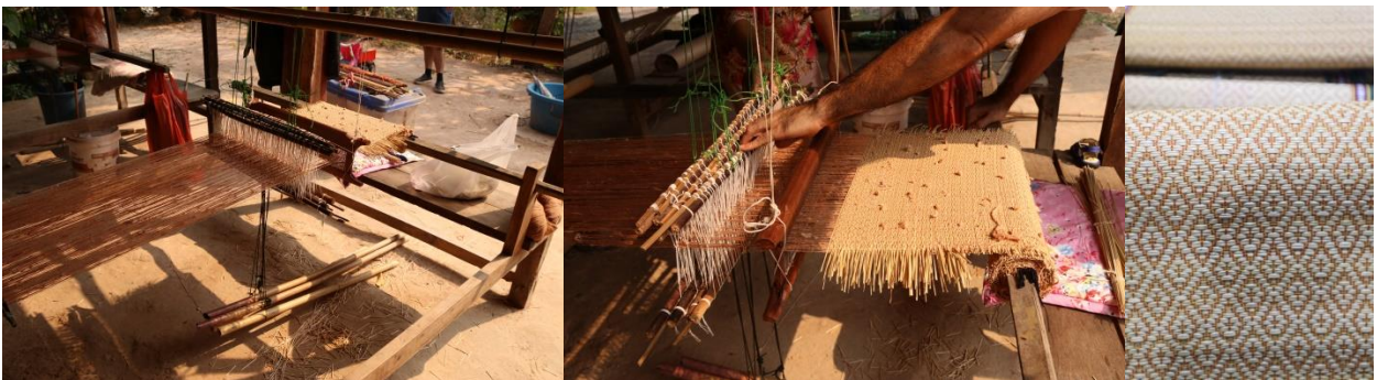
ภาพที่ 2.9 (จากซ้ายไปขวา) กีทอผ้าที่ประยุกต์มาทอเสื่อกก, การทอลายสี่เหลี่ยมขนมเปียกปูน ใช้ตะกอด 4 ตะกอด: เส้นยืนไหมอีรี่ พุ่งด้วยไหมอีรี่สลับเส้นกก, เสื่อกกลายสี่เหลี่ยมขนมเปียกปูน
