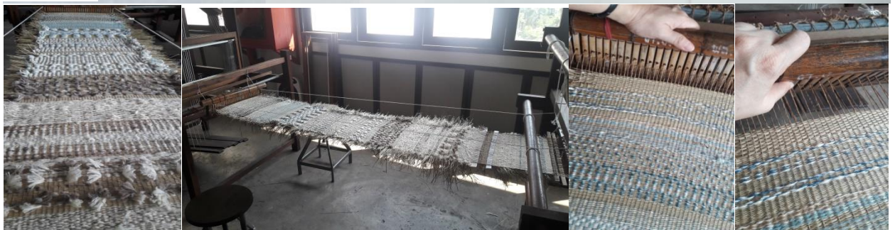
ภาพที่ 5.6 ต้นแบบชิ้นงานทอโดยนักออกแบบ ชั้นที่ 8 ใช้โครงสร้างการทอเสื่อกก ขนาด: กว้าง 40 ซม. ยาว 220 ซม.
