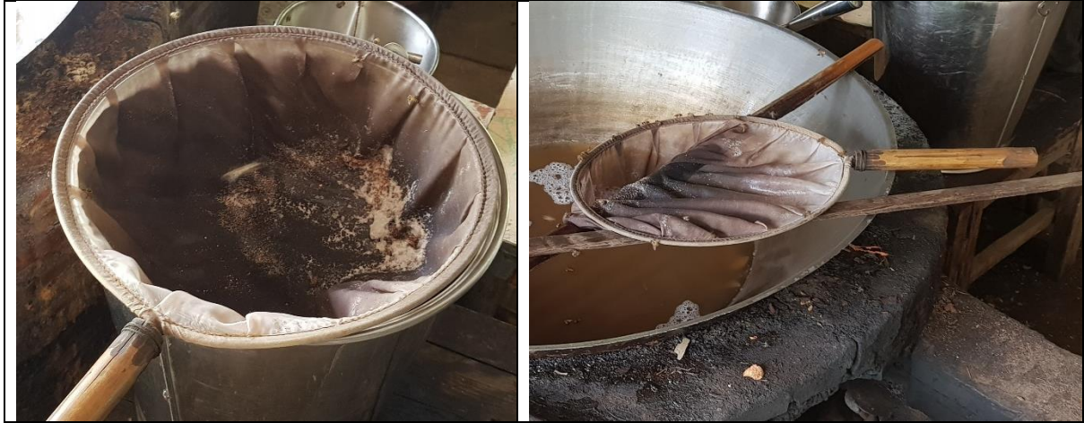
ภาพที่ 3.7 ที่กรองน้ำตาลทำจากผ้าดิบเย็บติดกับลวดวง และมีด้ามจับทำด้วยไม้ไผ่
