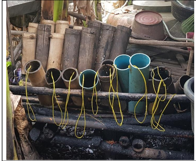
ภาพที่ 3.5 เตาที่ใช้รมควันเพื่อทำให้กระบอกไม้ไผ่หรือฟิวซีแห้ง
