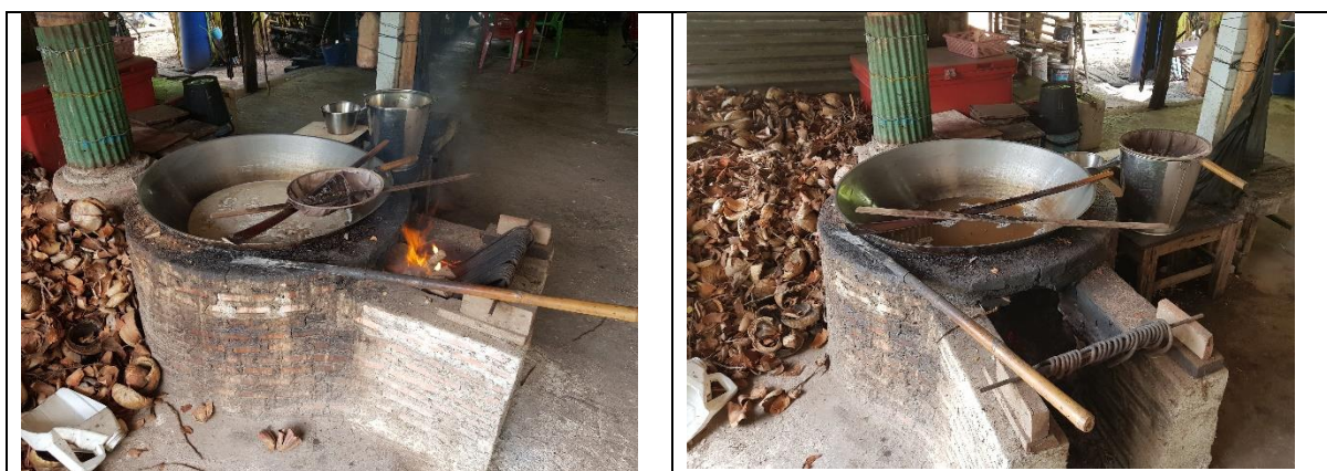
ภาพที่ 3.4 เตาเคี้ยวตาลที่ทำมาจากอิฐสีแดงและฉาบด้วยปูน
