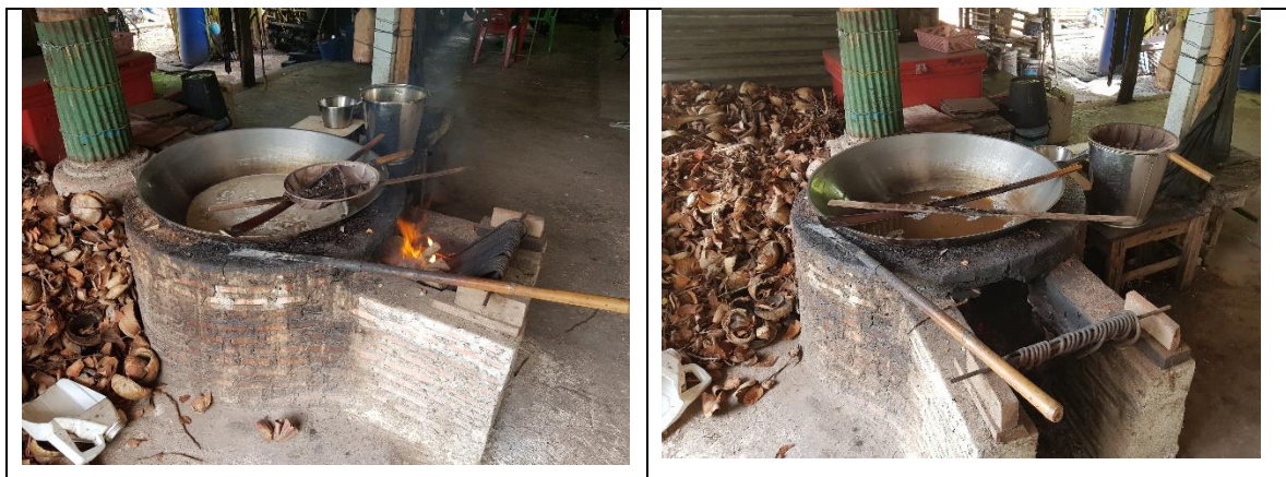
ภาพที่ ผนก 5 เตาเคี่ยวตาลที่ทำมาจากอิฐสีแดงและฉาบด้วยปูน ใช้ฟืนและกะลามะพร้าวเป็นเชื้อเพลิง
