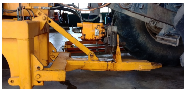
รูปที่ 24 โครงสำหรับการต่อพ่วงของเครื่องปรับระดับพื้นที่ตัวอย่าง ที่มา: จากการสรุปของโครงการวิจัย
