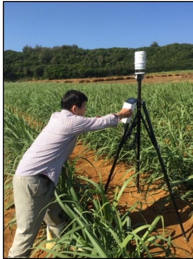
รูปที่ 46 สถานีตรวจอากาศและการติดตั้ง NDVI เพื่อติดตามการเจริญเติบโตของพืช
