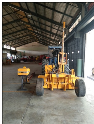
รูปที่ 20 เครื่องปรับระดับพื้นที่แบบเลเซอร์ตัวอย่าง
