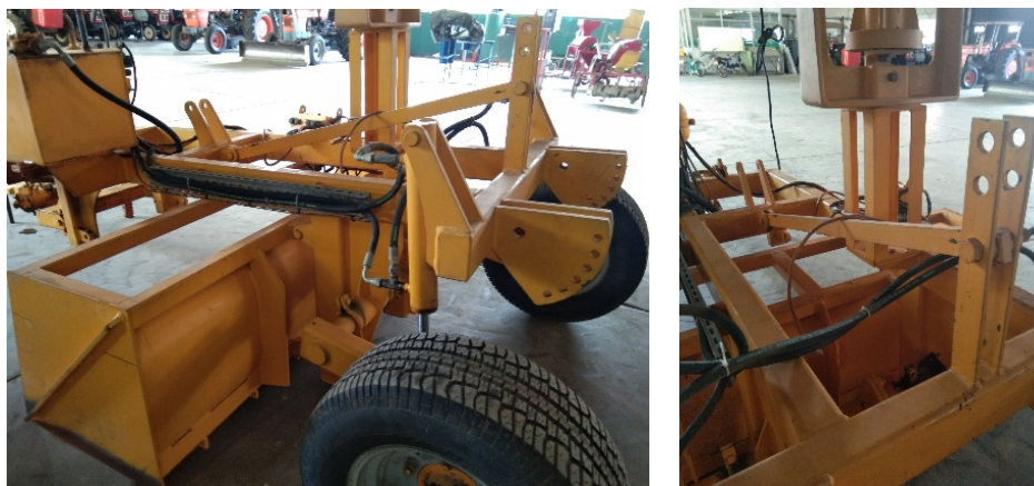
รูปที่ 22 โครงสร้างหลักของเครื่องปรับระดับพื้นที่ตัวอย่าง
