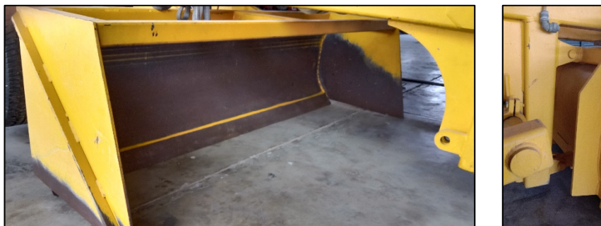
รูปที่ 23 โครงสร้างกล่องใบมีดตัวอย่างของเครื่องปรับระดับพื้นที่ (ซ้าย) และจุดยึดกับโครงสร้างหลัก (ขวา) ที่มา: จากการสรุปของโครงการวิจัย
