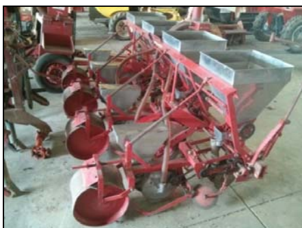
รูปที่ 12 เครื่องจ่ายปุ๋ยปรับอัตราได้ ส่วนโครงสร้างและกลไกการทำงาน
