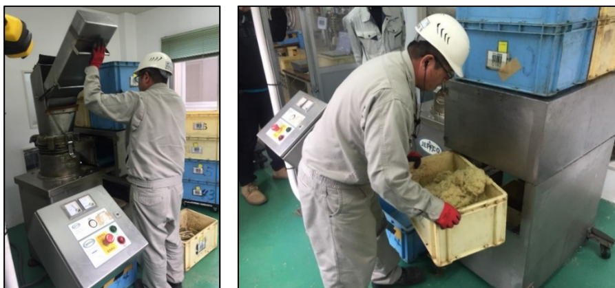
รูปที่ 53 การนำอ้อยสับย่อยจนละเอียดด้วยเครื่อง Shredder machine
