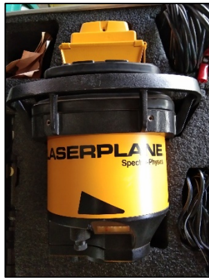
รูปที่ 27 อุปกรณ์ส่งสัญญาณเลเซอร์ตัวอย่างยี่ห้อ Laserplane
