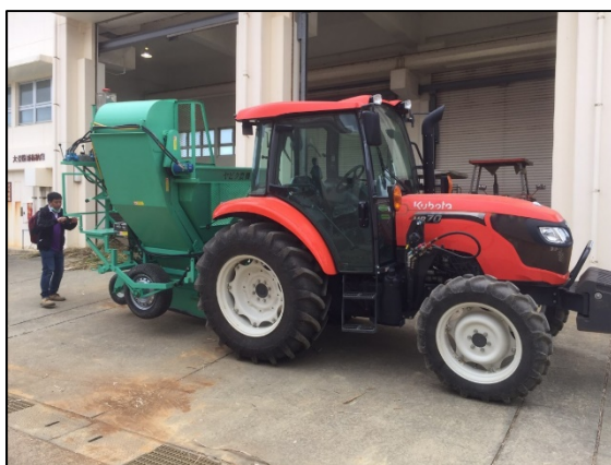
รูปที่ 47 การพัฒนาเครื่องปลูกอ้อยแบบท่อน (billet planter)
