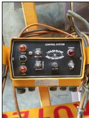
รูปที่ 28 อุปกรณ์ควบคุมการทำงานตัวอย่างยี่ห้อ Laserplane
