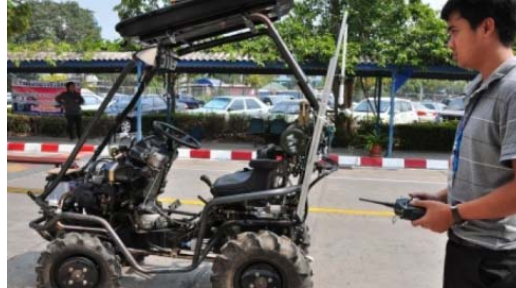
รูปที่ 9 รถไร้คนขับ หรือ Unmanned Ground Vehicle (UGV)
