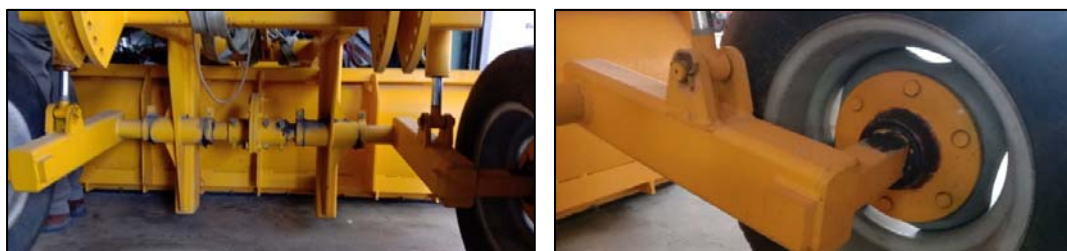
รูปที่ 25 โครงสร้างล้อของเครื่องปรับระดับพื้นที่ตัวอย่าง ที่มา: จากการสรุปของโครงการวิจัย
