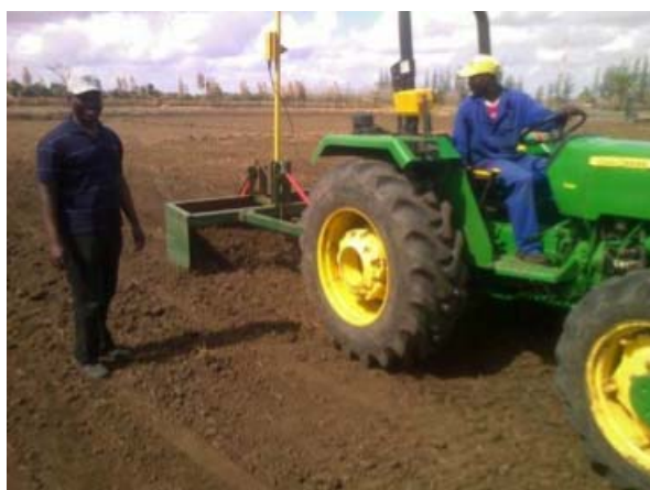
รูปที่ 16 เครื่องปรับระดับพื้นที่ด้วยการใช้แสงเลเซอร์ ที่มา: Rickman (n.d.)
