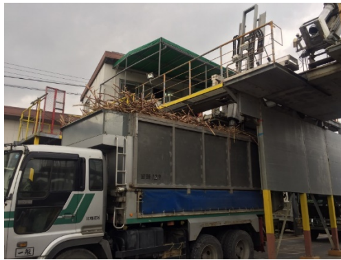
รูปที่ 52 การสุ่มตัวอย่างด้วยวิธี Core sampling จากระบบรถบรรทุก
