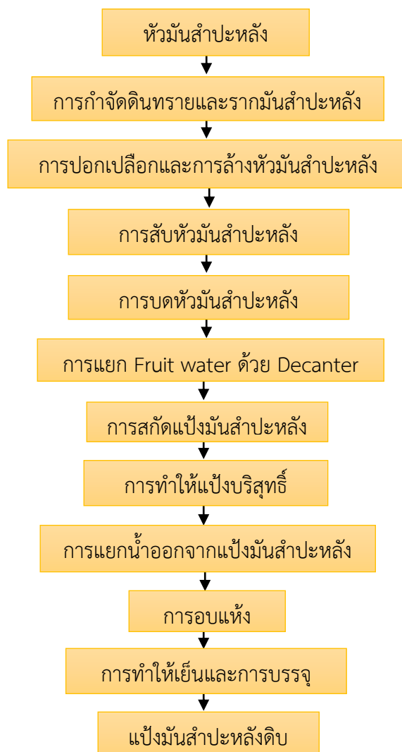
ภาพที่ 8 กระบวนการผลิตแป้งมันสำปะหลังดิบ
