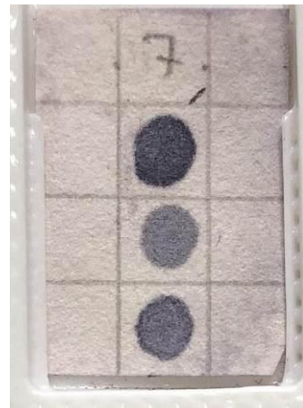
รูปที่ 12 ภาพถ่ายอุปกรณ์ตรวจวัดจากกล้องของโทรศัพท์ iphone 8 (A) ภาพเต็มของอุปกรณ์ตรวจวัดในบล็อกบรรจุ (B) ภาพตัดเฉพาะบริเวณที่มีการให้สัญญาณ ซึ่งแสดงให้เห็นความคมชัดที่สูงมาก
