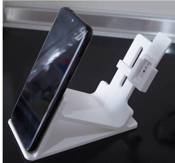
รูปที่ 11 แผนภาพจำลอง 3 มิติ (A) และภาพอุปกรณ์จริง (B) แสดงแท่นจับตัวอย่างและลักษณะการถ่ายภาพด้วยสมาร์ทโฟน
