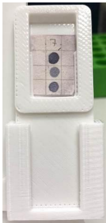
รูปที่ 12 ภาพถ่ายอุปกรณ์ตรวจวัดจากกล้องของโทรศัพท์ iphone 8 (A) ภาพเต็มของอุปกรณ์ตรวจวัดในบล็อกบรรจุ (B) ภาพตัดเฉพาะบริเวณที่มีการให้สัญญาณ ซึ่งแสดงให้เห็นความคมชัดที่สูงมาก
