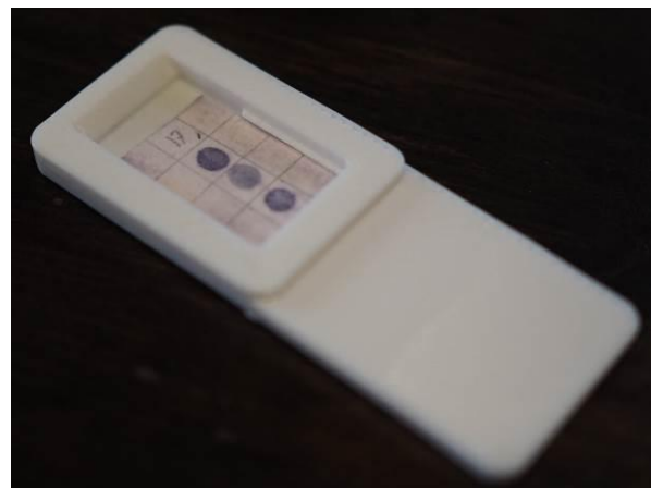
รูปที่ 10 แผนภาพจำลอง 3 มิติ (A) พร้อมภาพจริง (B) แสดงการออกแบบอุปกรณ์บรรจุอุปกรณ์ฐานกระดาษและการเป็นภาชนะบรรจุสารละลาย
