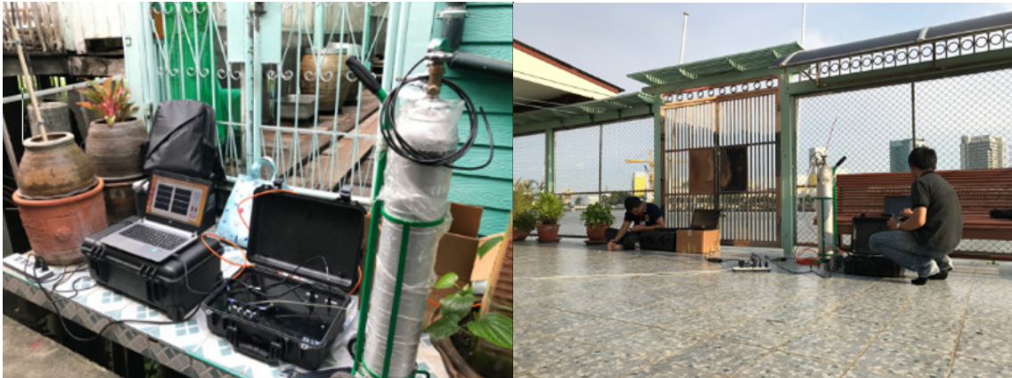
รูปที่ 3-18 ภาพแสดงการนำจมูกอิเล็กทรอนิกส์แบบกระเป๋าคู่สำหรับตรวจวัดกลิ่นในสิ่งแวดล้อม ไปใช้ตรวจวัดกลิ่นในชุมชนรอบโรงไฟฟ้า
