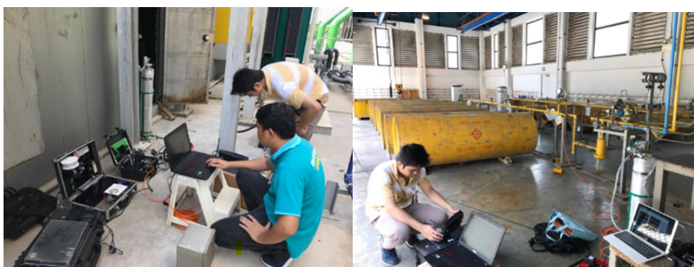
รูปที่ 3-17 ภาพแสดงการนำจมูกอิเล็กทรอนิกส์แบบกระเป๋าหิ้วสำหรับตรวจวัดกลิ่นในสิ่งแวดล้อม ไปใช้ตรวจวัดกลิ่นในโรงไฟฟ้า
