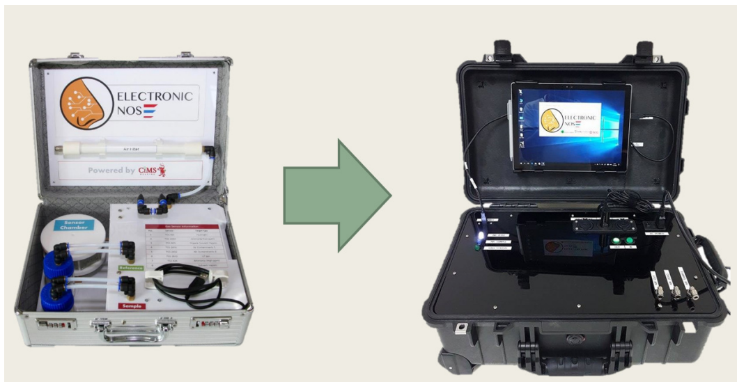
รูปที่ 3-7 ภาพแสดง การพัฒนาด้านแบบ Minimal Viable Product (MVP) เครื่องจุ่มกิโลอิเล็กทรอนิกส์สำหรับ ตรวจวัดกลิ่นในสิ่งแวดล้อม ที่เหมาะสมกับการใช้งานในภาคสนาม (Field Optimization) เช่น หน้าหนัก ระบบพลังงาน ความยากง่ายในการใช้งานกลางแจ้ง เป็นต้น
