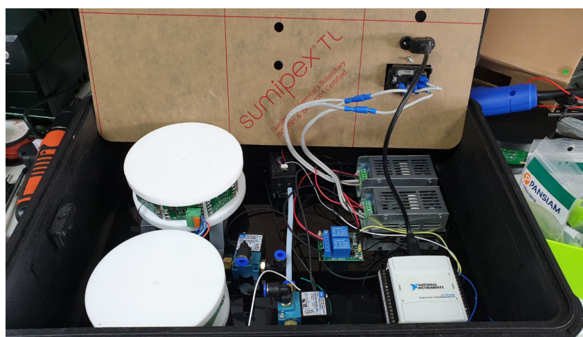
รูปที่ 3-6 ภาพแสดงการประกอบเครื่องจุ่มกิโลอิเล็กทรอนิกส์ ที่มีหัววัดเซนเซอร์ 2 ชุด โดยเป็นเซนเซอร์ประเภท metal oxide จำนวน 8 หัวเซนเซอร์ และเป็น polymer-carbon nanotube gas sensors จำนวน 8 หัวเซนเซอร์
