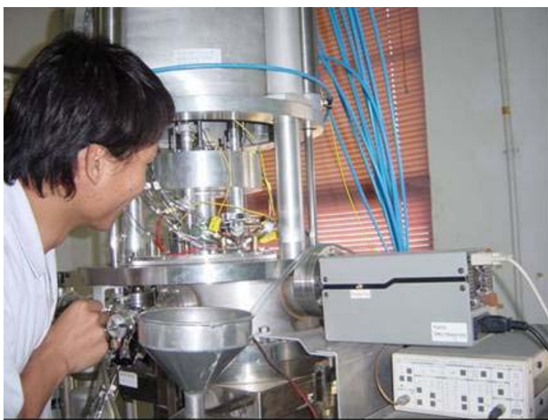
รูปที่ 3 เครื่องปฏิกรณ์ TAP-II ( Reactor – Pulse valve – Mass Spectroscopy)
