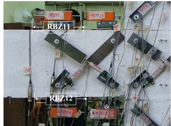
รูปที่ 4.17 ภาพถ่ายเครื่องมือวัดมุมหมุนคัตในคาน
