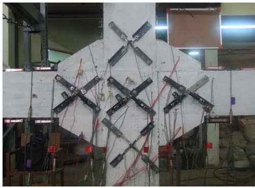
รูปที่ 5.18 ภาพถ่ายเปรียบเทียบกับ มิติและรายละเอียดการเสริมเหล็กในจุดต่อ ของชินทดสอบ PJE1 –PJE7 (ต่อ)
