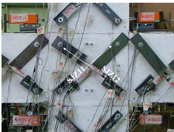
รูปที่ 4.20 เครื่องมือวัดการเปลี่ยนรูปเฉือนในจุดต่อ
