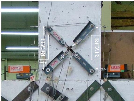
รูปที่ 4.16 ภาพถ่ายเครื่องมือวัดมุมหมุนคัตในเสา
