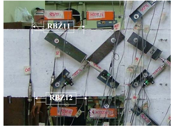
รูปที่ 4.17 ภาพถ่ายเครื่องมือวัดมุมหมุนตัดในคาน
