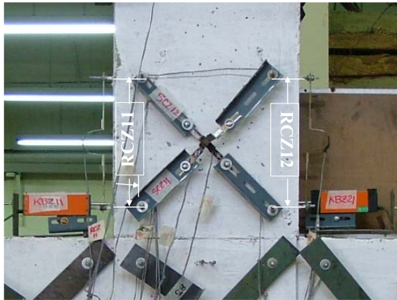
รูปที่ 4.16 ภาพถ่ายเครื่องมือวัดมุมหมุนตัดในเสา
