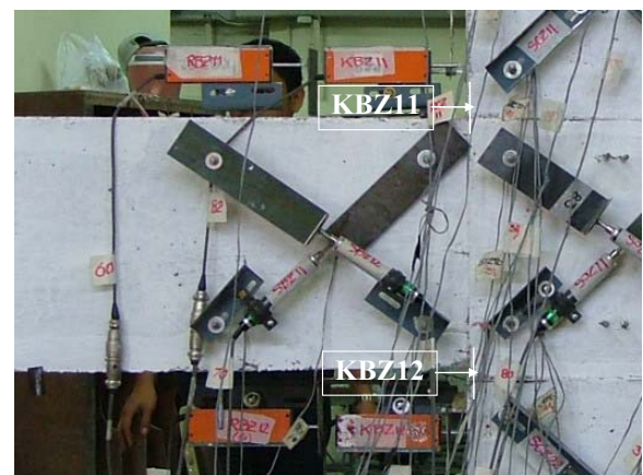
รูปที่ 4.21 เครื่องมือวัดมุมหมุนเกร็งในคาน
