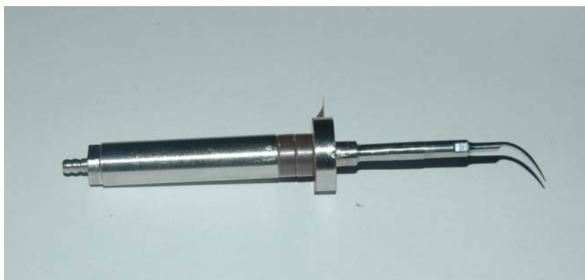
รูปที่ 10. เครื่องขัดหินปูนที่มีการนำเอาพิโซอิเล็กทริกเซรามิกมาประยุกต์ใช้
