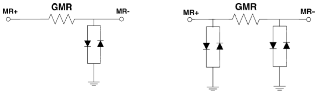
ภาพที่ 2.39 การต่อไดโอด (ก) 1 ข้าง (ข) 2 ข้าง [25]
