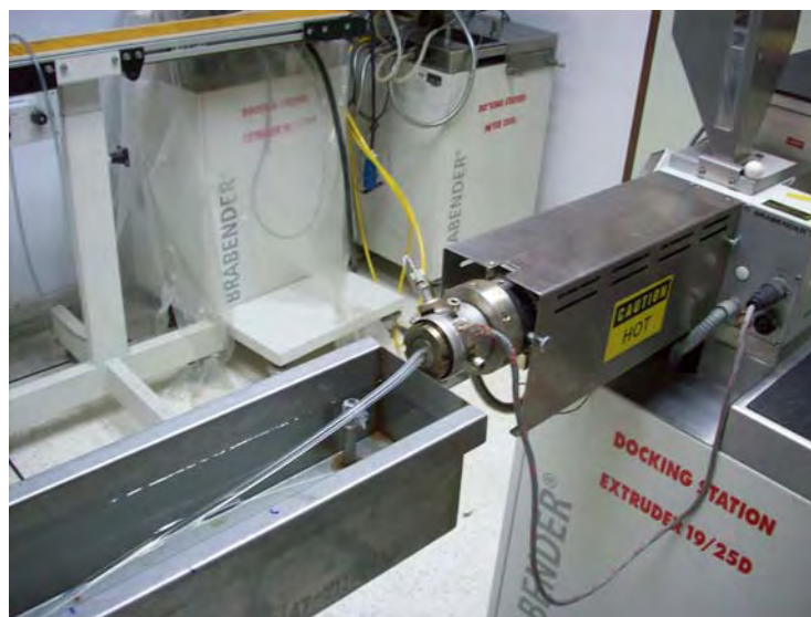
รูปที่ 1 ภาพแสดงการขึ้นรูปท่อกลวงด้วยเครื่องอัดรีดสกรูเดี่ยว
