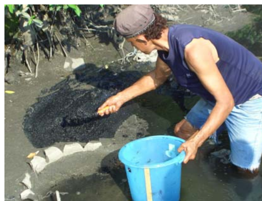
รูปที่ ก.1.4 บริเวณจุดเก็บตัวอย่างและการเก็บตัวอย่างน้ำและตะกอนของ Site A4 รวมถึงการ ปาดชั้นหน้าตะกอนทิ้งก่อนเก็บตัวอย่าง
