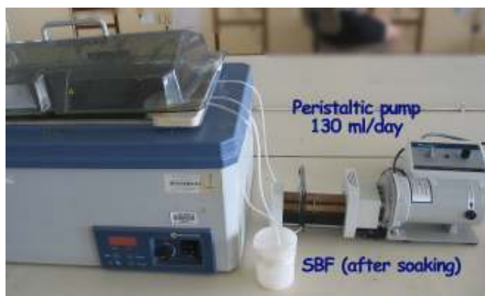
รูปที่ 4.1 ชุดทดสอบภายใต้ระบบจำลองของร่างกาย
