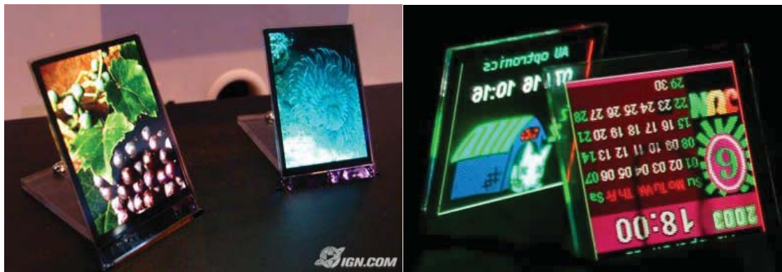
รูปที่ 1 ตัวอย่างหน้าจอแสดงผลภาพสีที่ทำด้วย OLED
